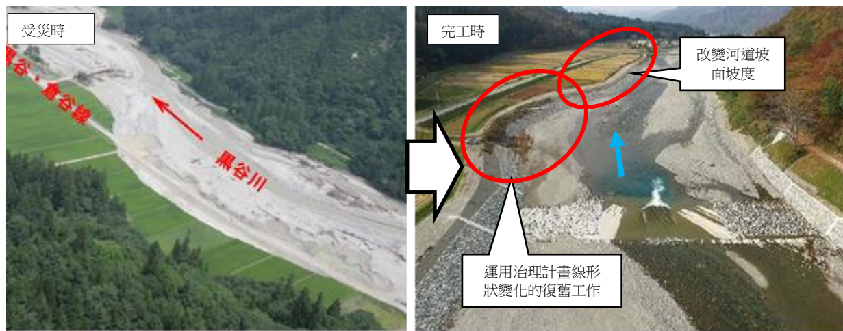
照片 3.10 活用受災時平面形狀，實施河道復舊的案例（黑谷川：福島縣）
