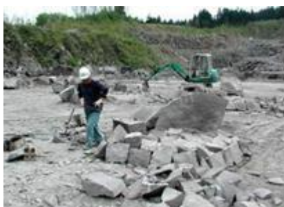
採石場切割完成的石塊，加工做成四角石材等。
