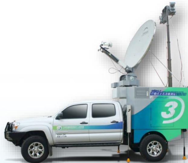
土石流行動式觀測站
