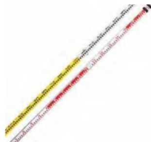
測量用鋁質量尺 容易購得，可用來測量， 數字與刻度較小。
