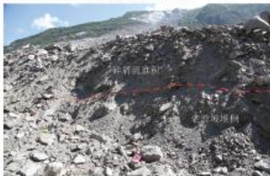
(c) 碎屑流堆积于老滑坡体上
