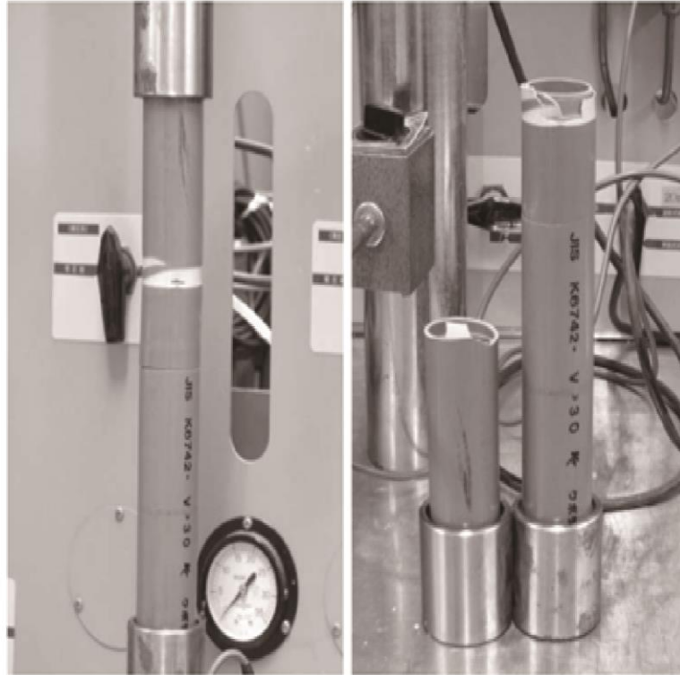
拉伸試驗的斷裂後，內牙根部的斷裂（VP30-1）
