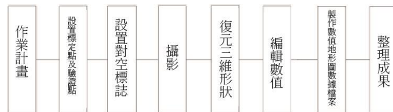
圖37 透過使用UAV所拍攝的航空照片進行三維點雲測量的各工程作業區分及順序 出處：「利用UAV進行公共測量手冊（草案）平成29年3月」（國土交通省）
