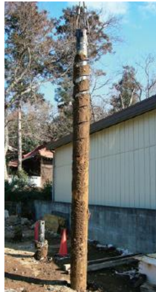
圖一 1 迴轉貫入・支撐力發展機制（左圖）與載重試驗後拉出來的樁體（右照片）
