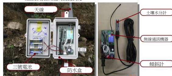
坡面崩塌感測器之系統結構
