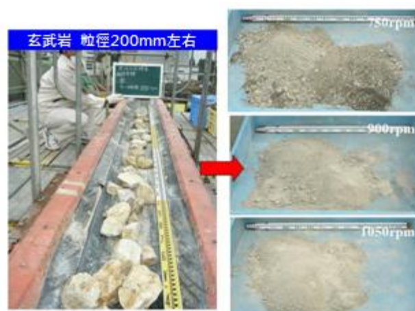
圖一4 技術的特點2（破碎軟岩・調整粒度）
