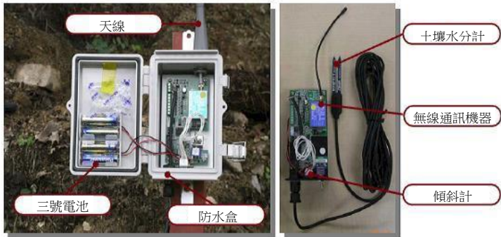
照片－1 坡面崩塌感測器之系統結構
