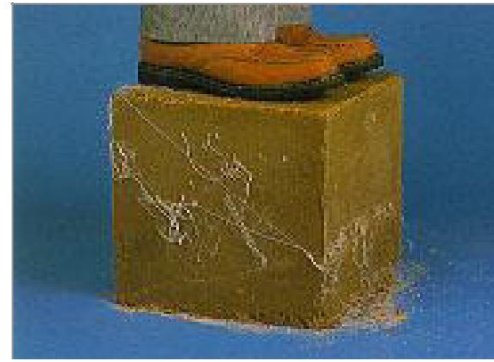
照片－2 連續纖維補強土
