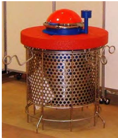
圖 4.10 空投式水位觀測浮筒外觀
