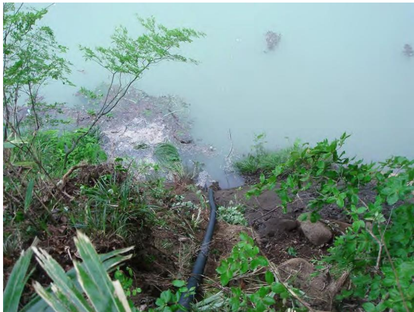
圖 4.9 水壓式水位計設置案例
