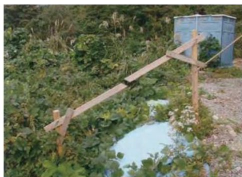
圖 4.21 簡易變位板的外觀與測定概要圖
