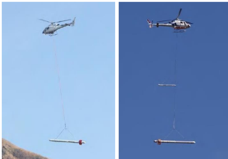
圖 16 空中電磁探測實施狀況（左：RESOLVE 型 右：DIGHEM 型）
