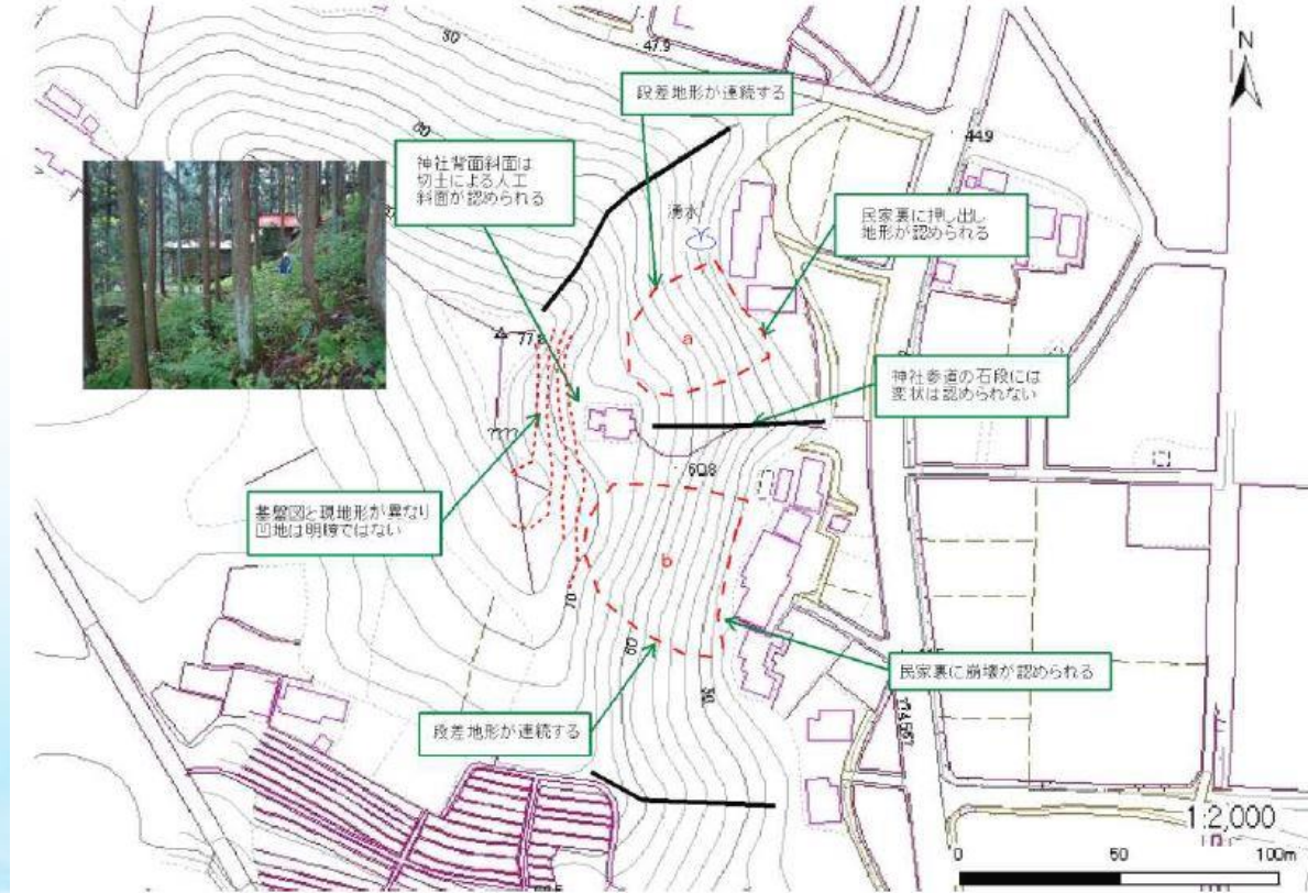
図 1-5-4 調査への基盤図と現地地形の相違の記載例 (様式 2-6)
