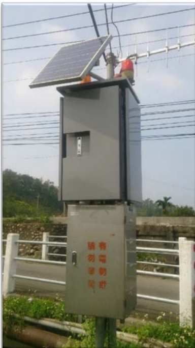
水位、雨量、影像即時監控系統
