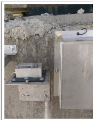
橋梁震動/橋墩雙軸傾斜儀
