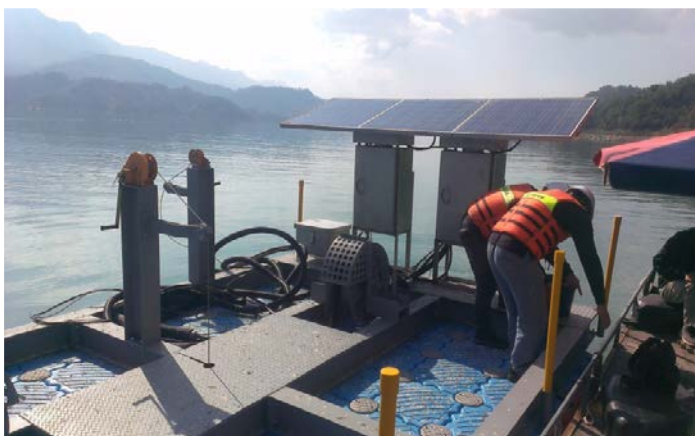
南化水庫水質泥砂濃度即時監控系統
