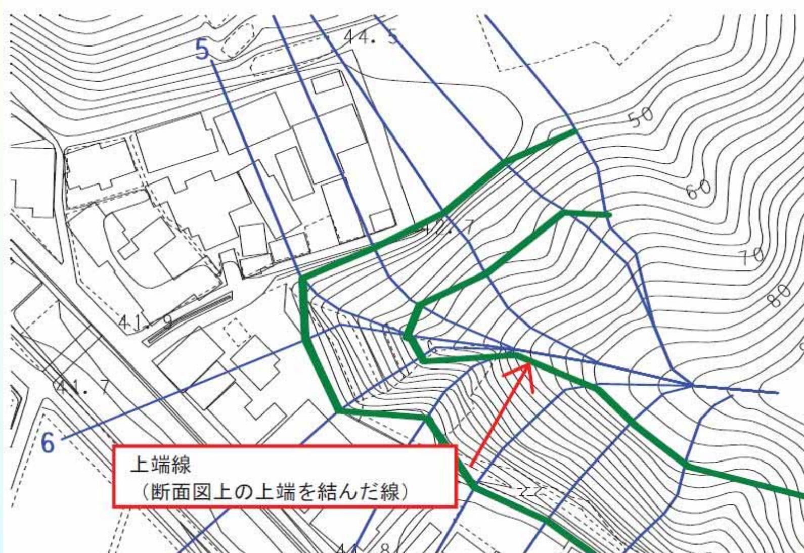
図 1.18 急傾斜地の上端の設定例（平面図上）
