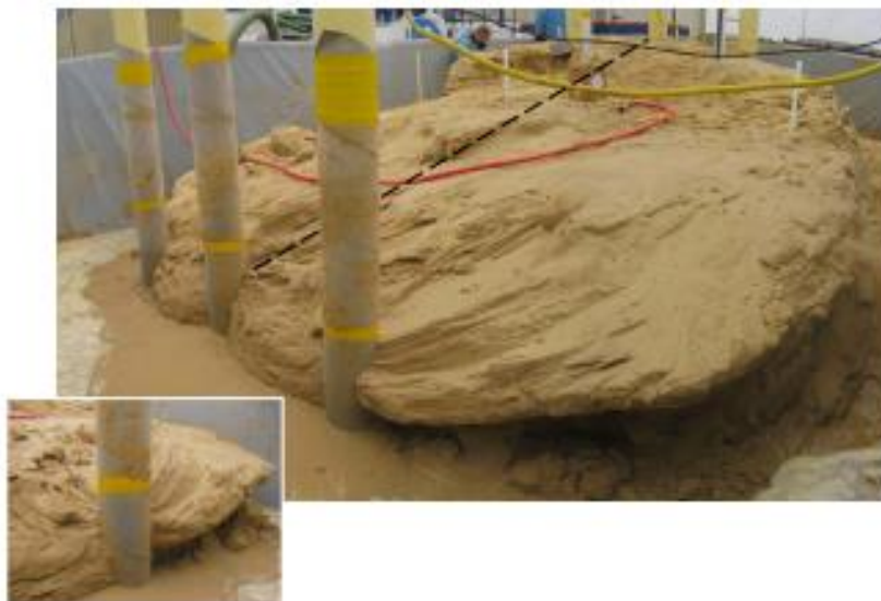
照片 4-3 大規模砂粒膠結試驗
