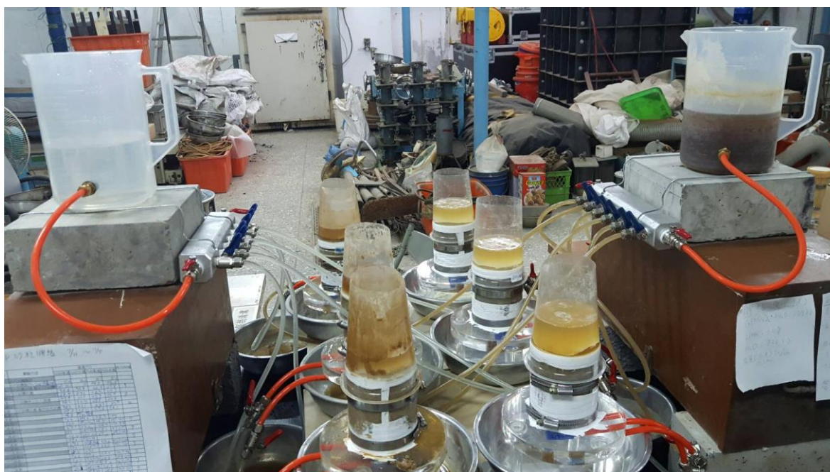
照片 4-12 抗壓用之重模試體 MICP 滴灌圖
