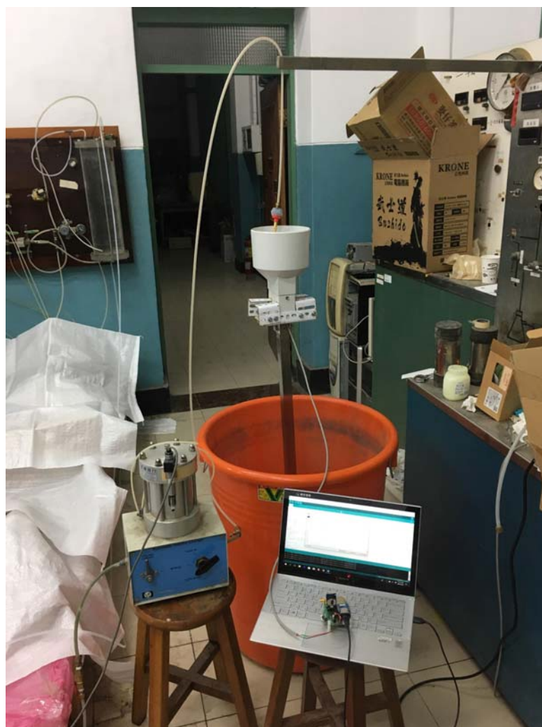
圖 3-12 雨量計率定配置
