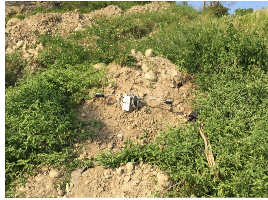
照片 3-7 現地測試布置(A)鉸桿式 (B)圓柱式體式
