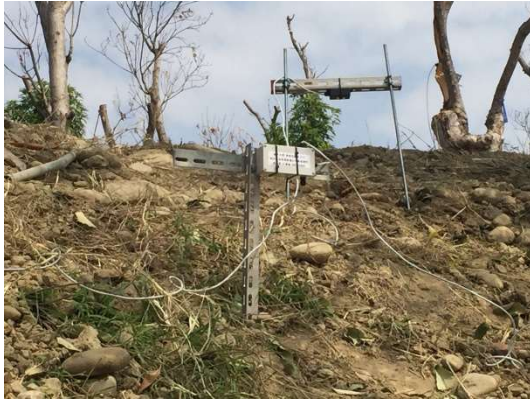
照片 3-7 現地測試布置(A)鉸桿式 (B)圓柱式體式
