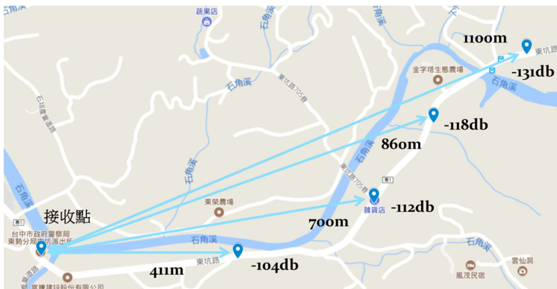
圖 3-20(B) 短天線 LoRa 無線電傳輸測試(山區無通視環境)
