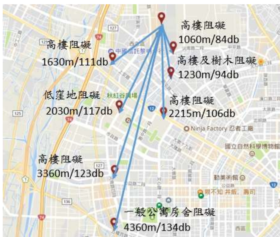
圖 3-21(A) 長天線 LoRa 無線電傳輸測試(平地無通視環境)
