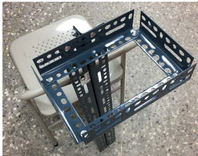
圖 4-27、放置太陽能板之座台
