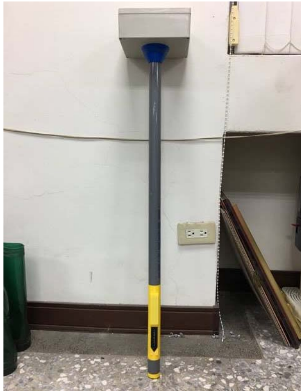
圖 4-24、放置含水量計(Soil moisture sensor v2.7.3)之外構
