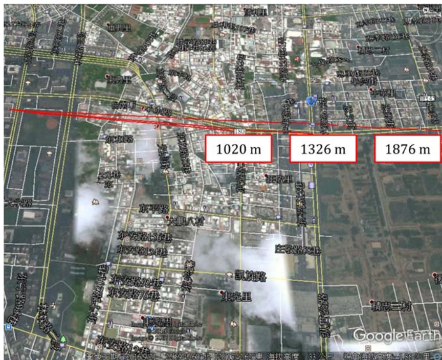
圖 4-10、最遠傳輸距離測試—量測點分布與量測距離
