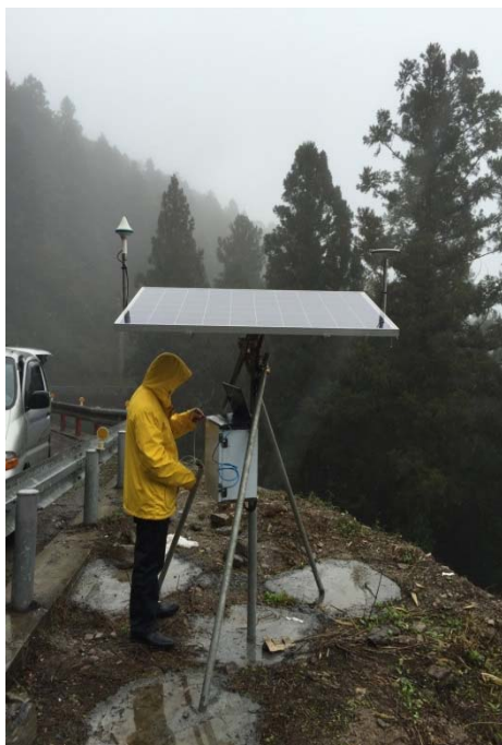
圖 1-11、現地照片(a)單頻 GPS 基線調整(b)水壓計&地電阻裝設
