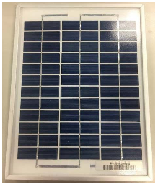
圖 4-20、本次測試所使用之太陽能板
