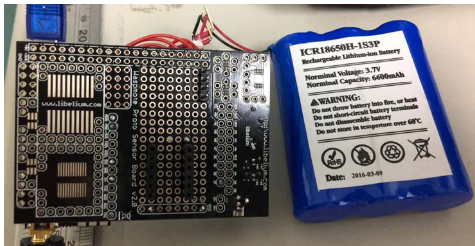
圖 4-25、傾斜儀(SCA103T-D04)安置前
