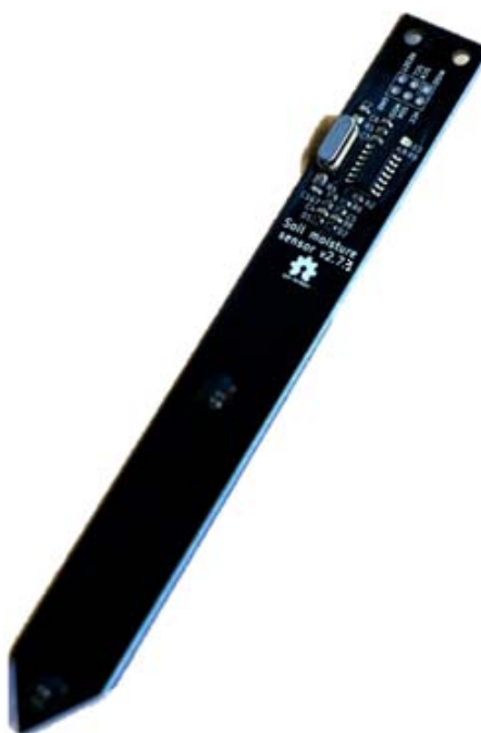
圖 4-13、含水量計 Soil moisture sensor v2.7.3 圖(摘自網路)
