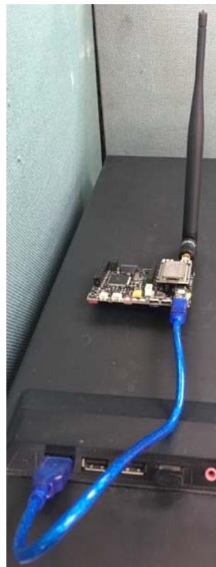
圖 4-16、LoRa 接收端配置圖
