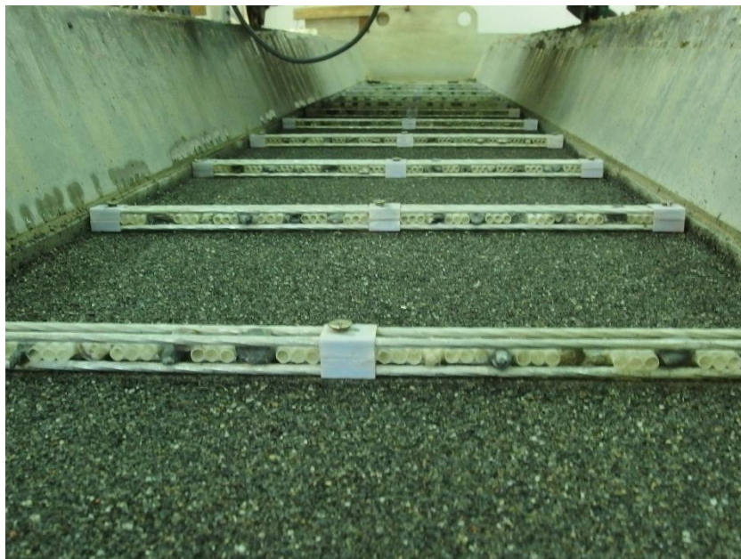
圖 3-5 透水式 D 型固床工模型
