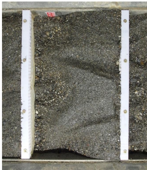
圖 4 - 16 透水式 B 型固床工間渠床淘刷之發展
