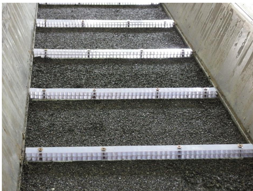
圖 3-3 透水式 B 型固床工模型
