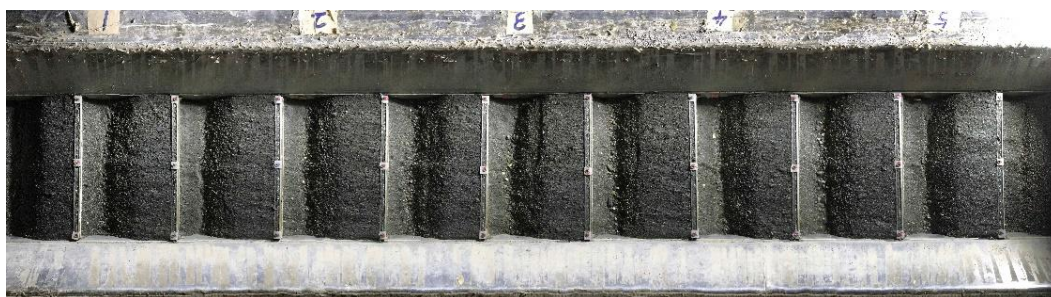
(C). S=0.08 、 D_{50}=0.85\text{mm} 、 Q=8.7 \times 10^{-4}\text{cms} 全景照
