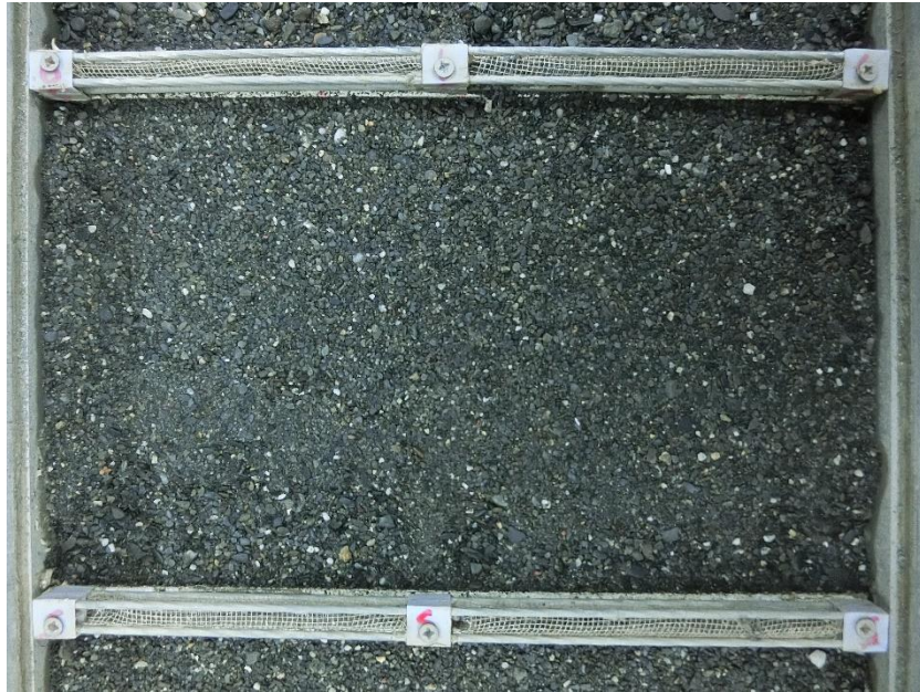
圖 3-4 透水式 C 型固床工模型
