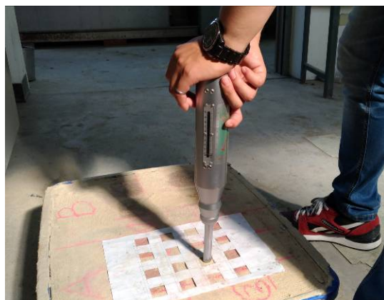
圖 3-11 實驗室試體之反彈錘試驗
