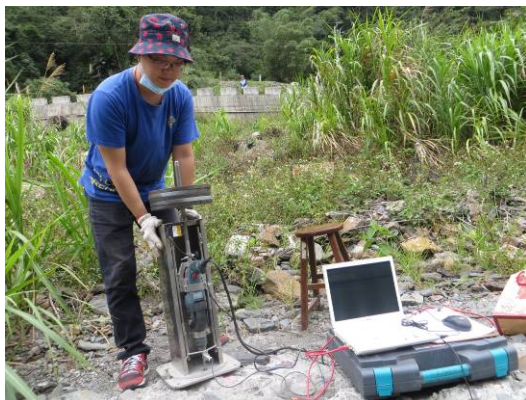
圖 3-36 合望溪現地構造物之微鑽孔試驗
