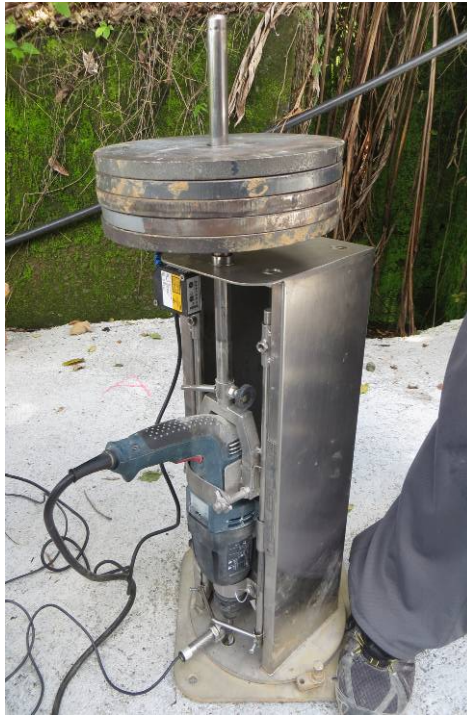
圖 3-5 微鑽孔檢測裝置
