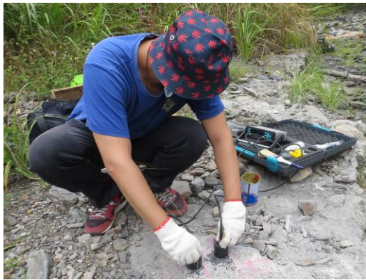
圖 3-35 合望溪現地構造物之超音波波速量測試驗
