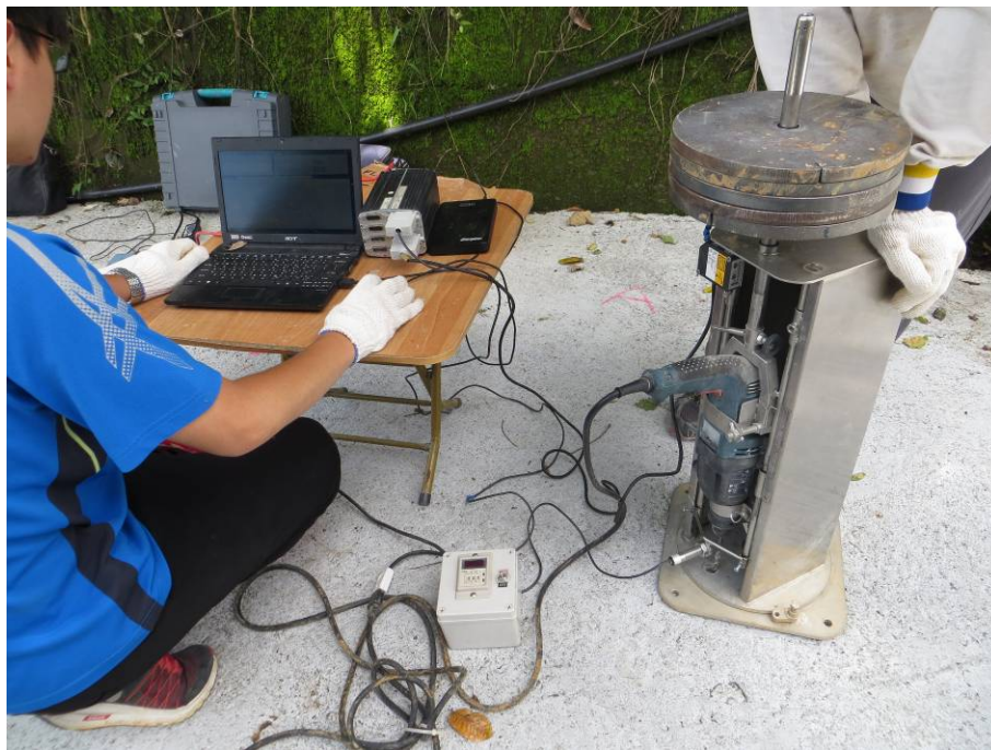
圖 3-6 微鑽孔檢測試驗
