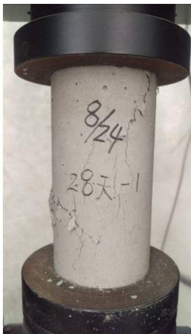
圖 3-10 圓柱試體之抗壓試驗
