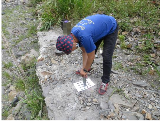
圖 3-34 合望溪現地構造物之反彈鎚試驗
