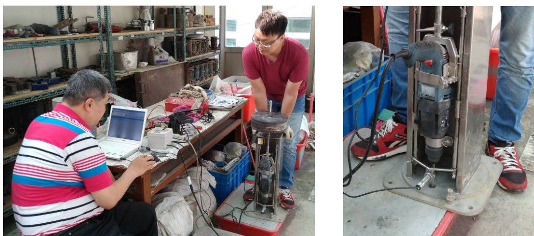
圖 3-13 實驗室試體之微鑽孔試驗
