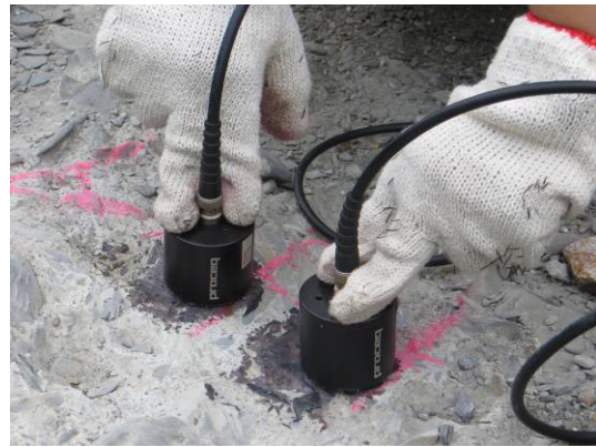
圖 3-35 合望溪現地構造物之超音波波速量測試驗
