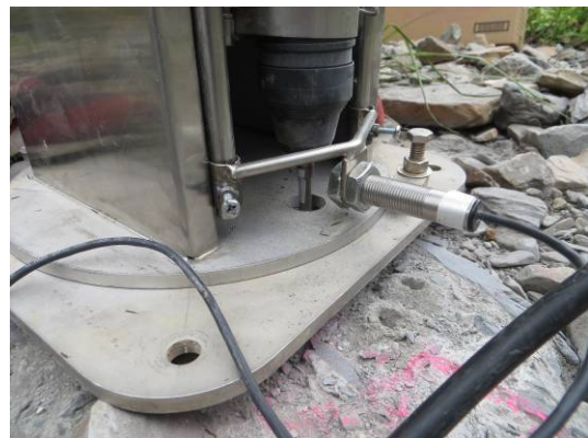
圖 3-36 合望溪現地構造物之微鑽孔試驗
