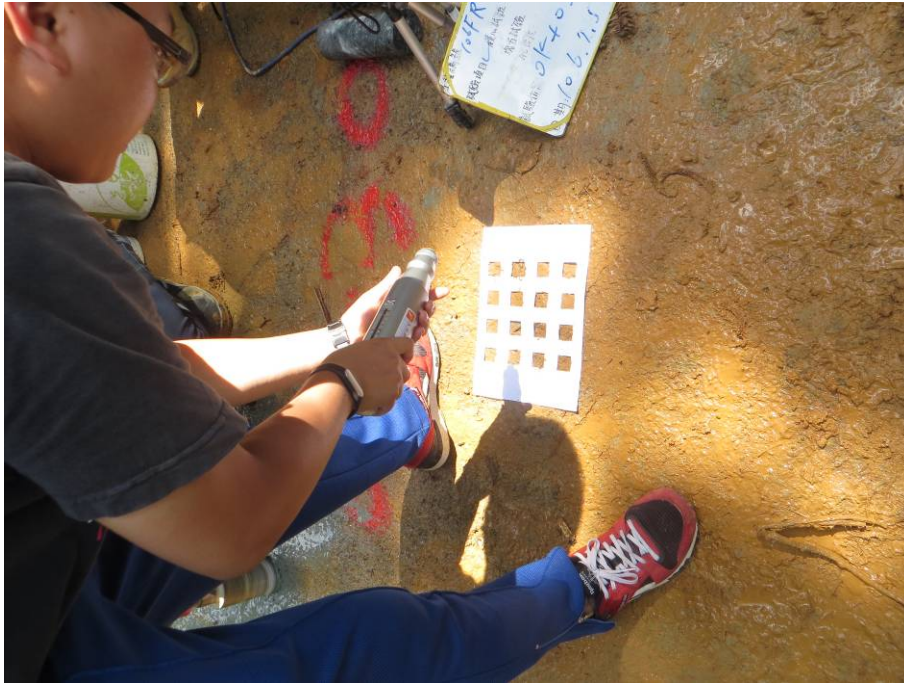
圖 3-26 虎頭山農路工程之反彈鎚試驗
