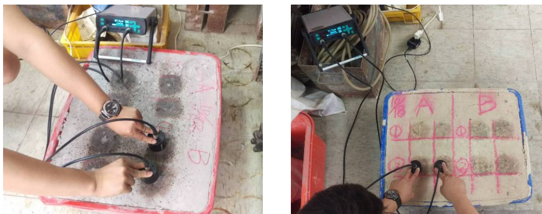
圖 3-12 實驗室試體之超音波波速量測試驗
