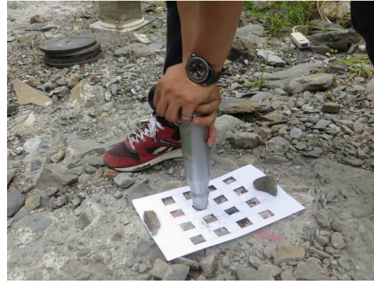
圖 3-34 合望溪現地構造物之反彈鎚試驗
