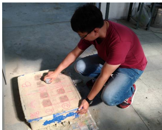
圖 3-11 實驗室試體之反彈錘試驗
