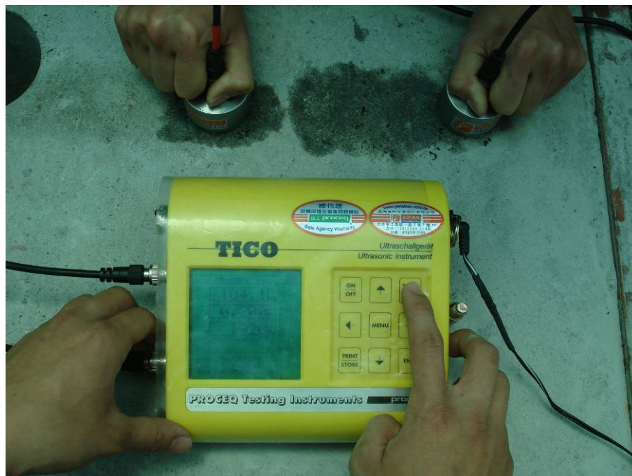
圖 2-4 超音波量測表面波速之試驗配置
