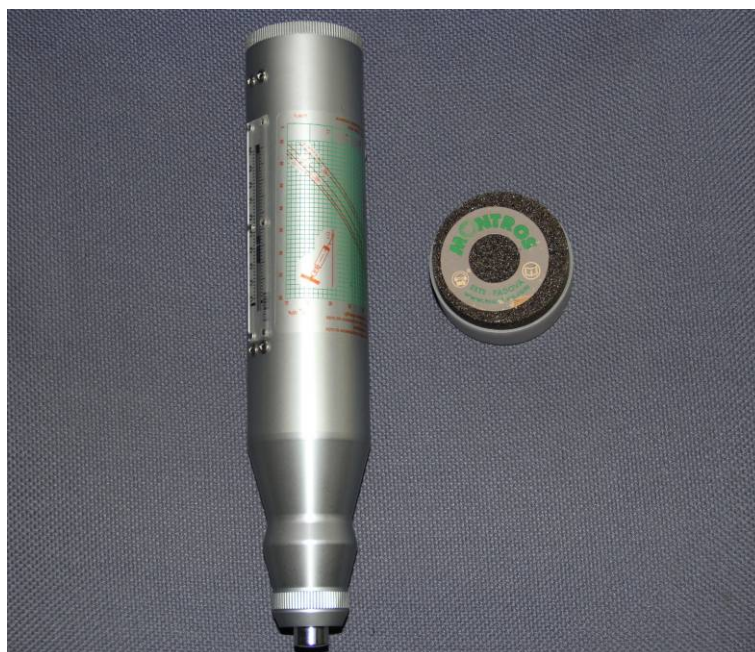
圖 2-2 義大利 CONTROLS 58-C0181/G 反彈鎚
