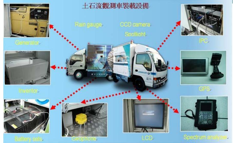
坡地監測系統示意圖
