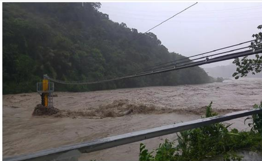
摘圖-1 梅姬颱風洪峰流量下觀測樁運作照片(2016/09/27 17 時)
