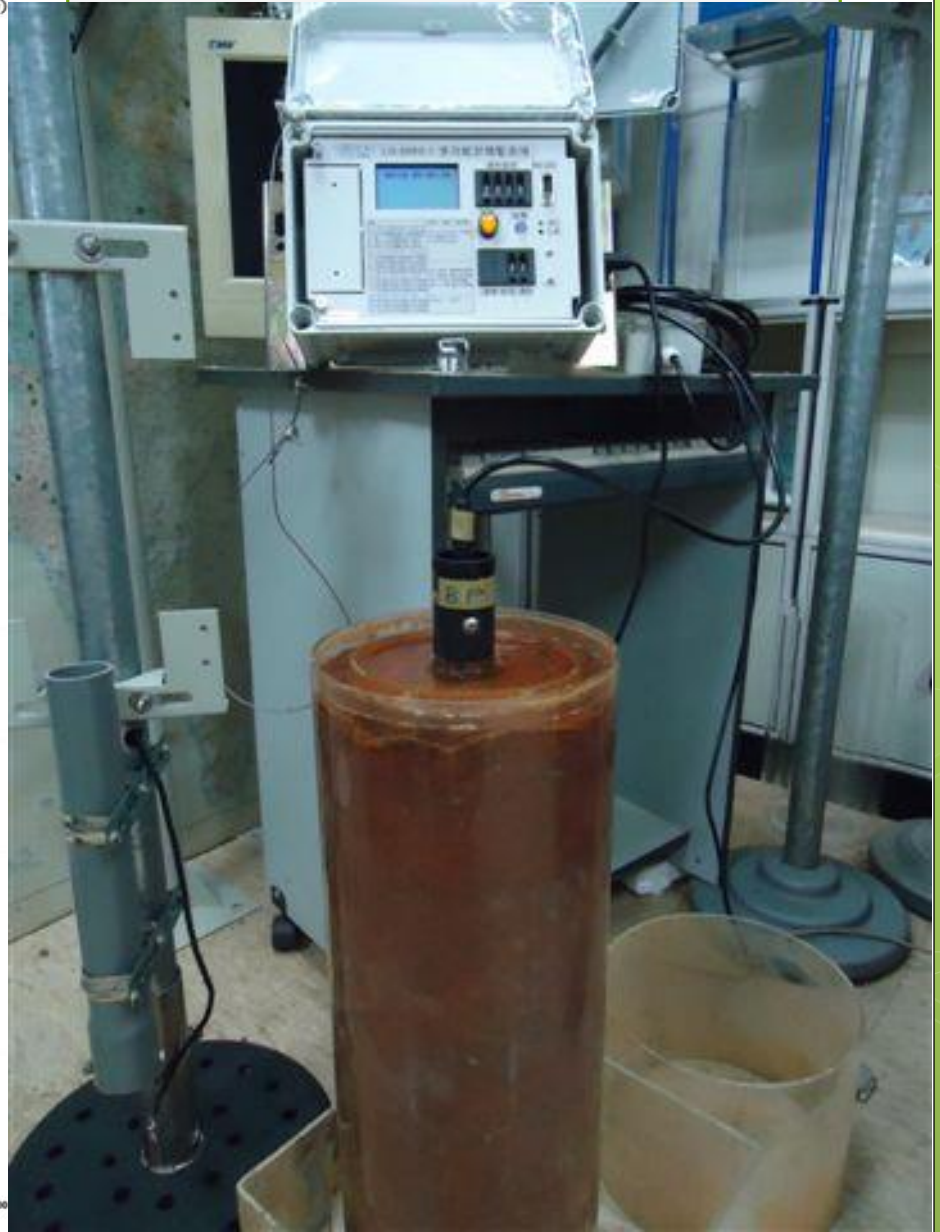
台灣 T285-2SC 差分式多層土水導電感測器 土壤入滲觀測紀錄 @ 10 min (10/31 16:00-23:00)
