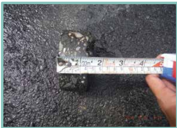
▲ 瀝青混凝土鑽心試體厚度未達設計標準
