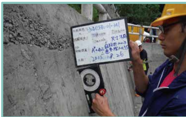
▲ 擋土牆斜率不符設計
