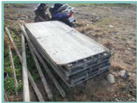
▲ 模板表面釘孔與破損
