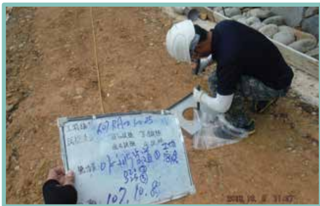
▲ 步道進行工地密度試驗是否符合設計要求
