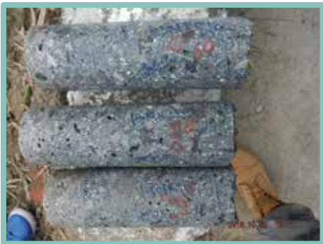
▲ 鑽心斷面粗骨材小於混凝土配比標稱粒徑
