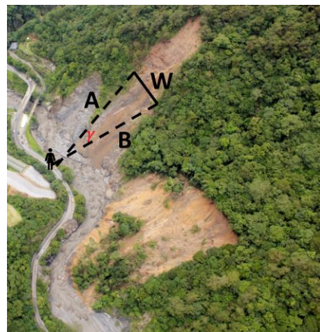
圖 4-7 崩塌地寬度量測示意圖
