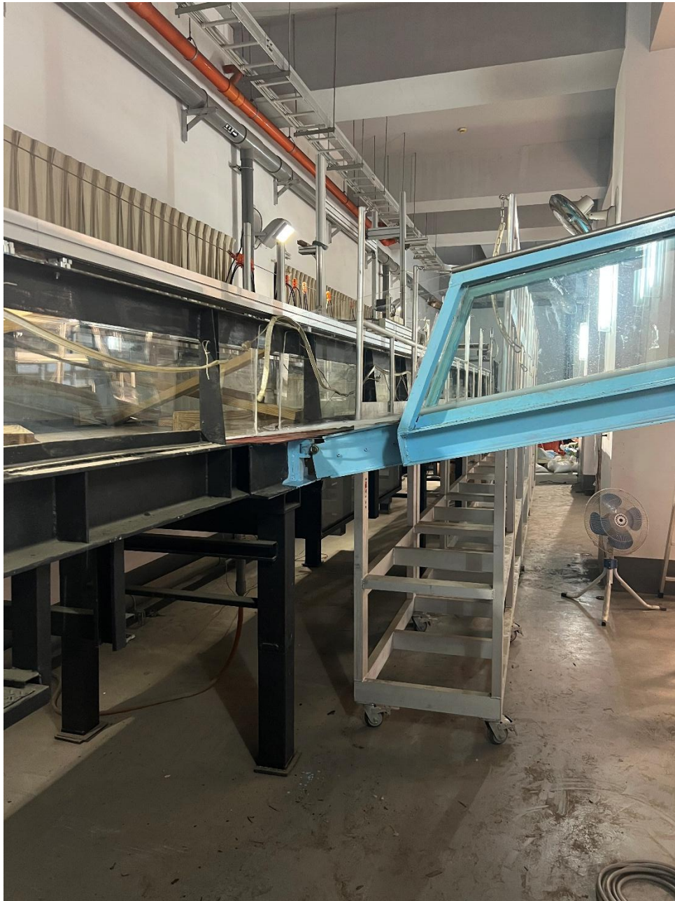
圖 2-48 本計畫擬建置應用之玻璃水槽試驗設備示意圖(主支流匯接)
