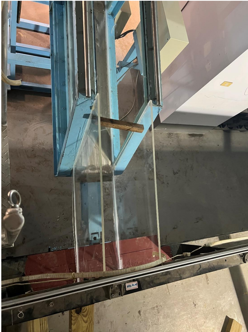
圖 2-49 本計畫擬建置應用之玻璃水槽試驗設備示意圖(主支流匯接)
