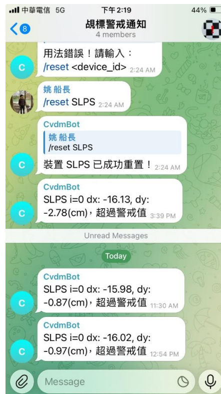
圖 3-42 電腦視覺變位監測儀器告警推播通知系統
