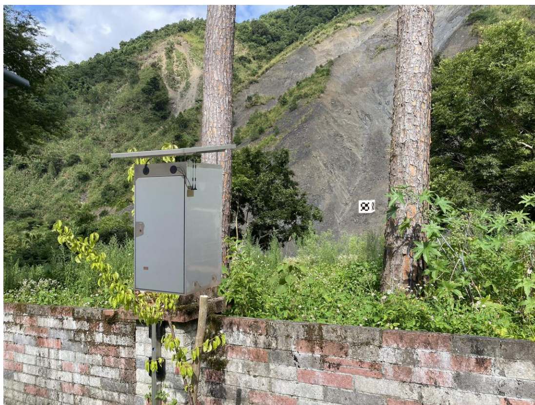
圖 3-25 秀巒崩塌區設置儀器現地示意圖
