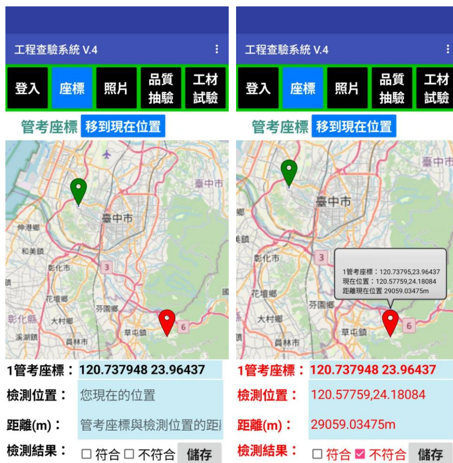
圖 13：工程查驗 App 自動計算查驗人員與管考座標間距離
