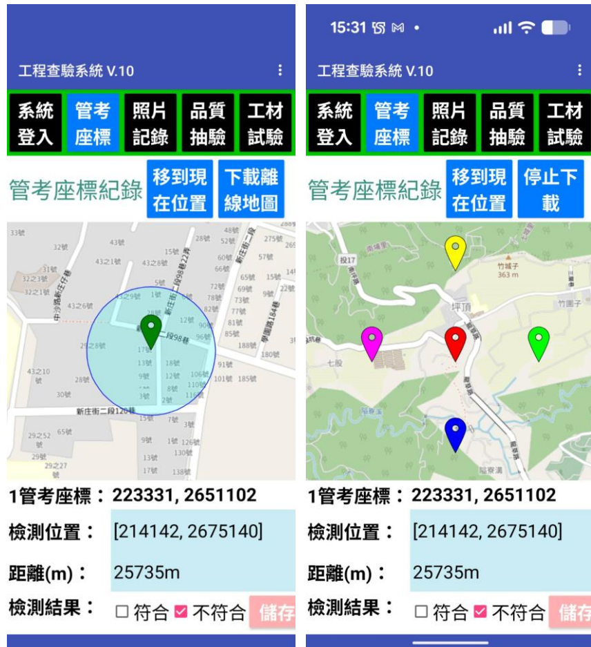
圖 14：工程查驗 App 提供下載 OSM 離線地圖之功能
