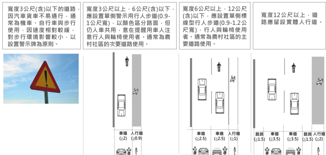
圖 5-1 強化道路人行空間人車分離的改善策略示意圖
