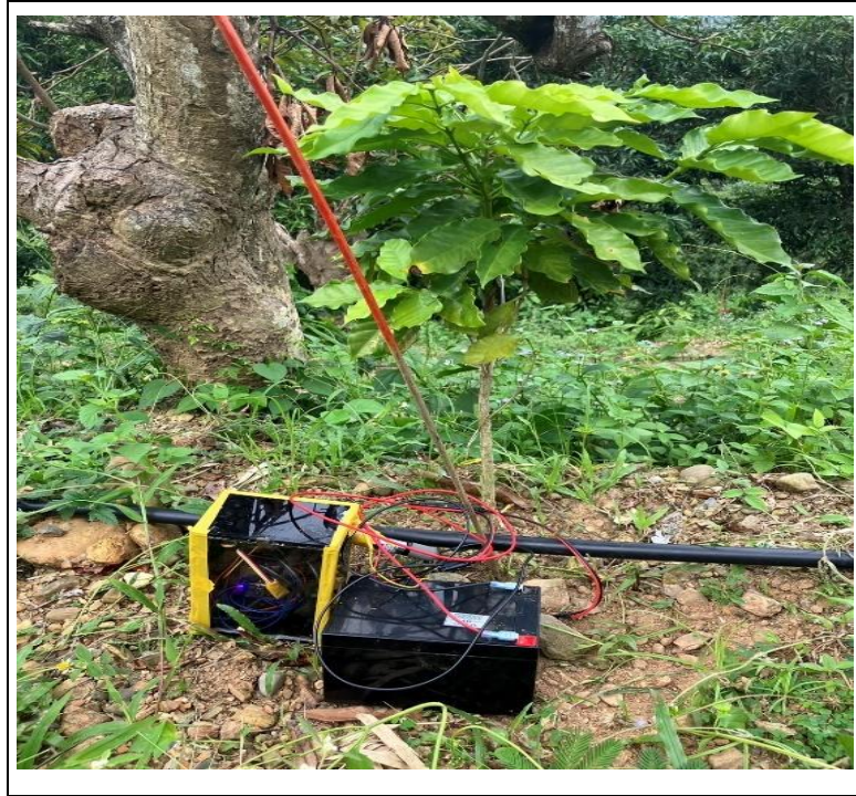
圖 3-21 12 V 鉛酸電瓶電能供應田間感測器
