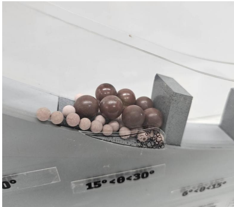
圖 3-20 土石流之土砂顆粒於不同分區之運移樣態變化模型機關設計
