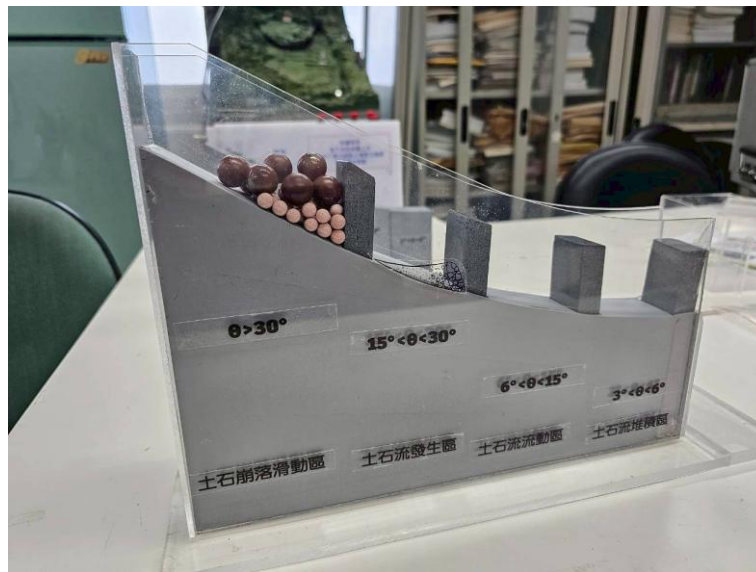
圖 3-5 土石流之土砂顆粒於不同分區之運移樣態變化模型
