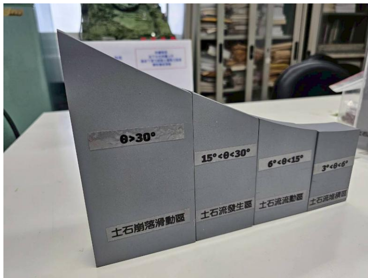
圖 3-4 土石流型土砂運移過程之坡度變化分區模型
