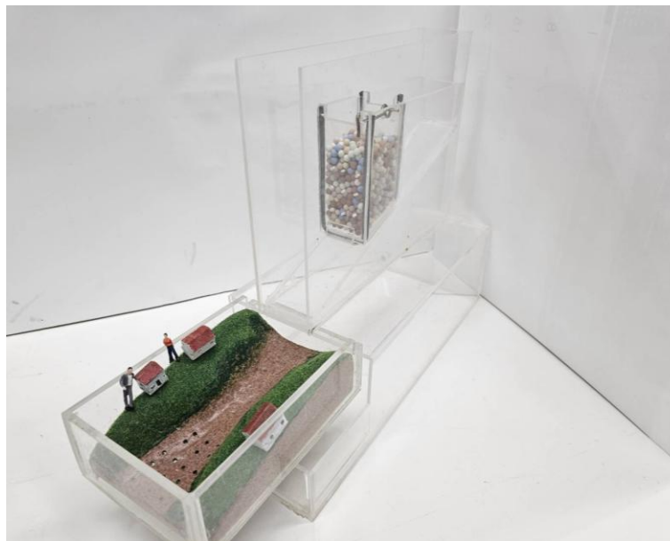
圖 3-21 堰塞湖型之發展形成及潰壩發生的歷程模型機關設計
