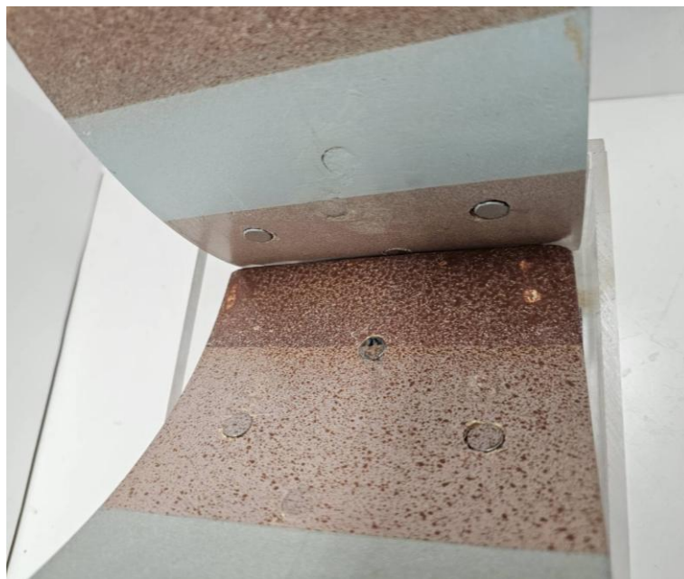
圖 3-14 地層剖面隨地層滑動後之地層岩性分布變化模型機關設計- 以磁鐵連接滑動塊體
