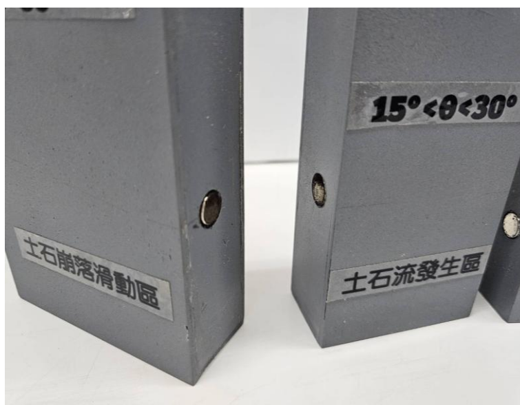
圖 3-17 土石流型土砂運移過程之坡度變化分區模型機關設計-以磁
