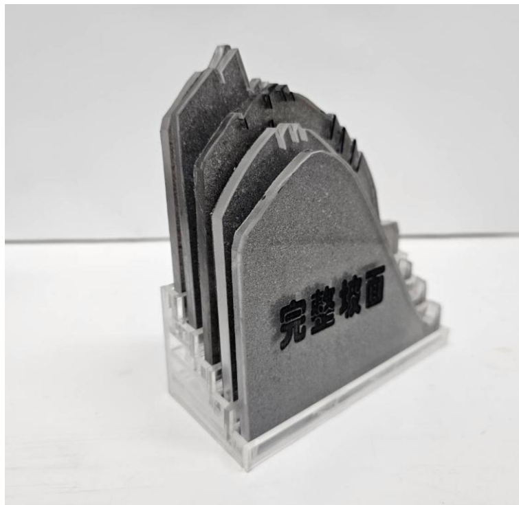
圖 3-7 滑動面演化過程模型階梯式展示座設計
