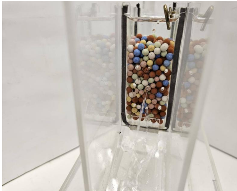
圖 3-22 堰塞湖型之發展形成及潰壩發生的歷程模型機關設計-面板
