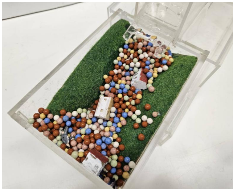
圖 3-25 堰塞湖型之發展形成及潰壩發生的歷程模型機關設計-潰壩
