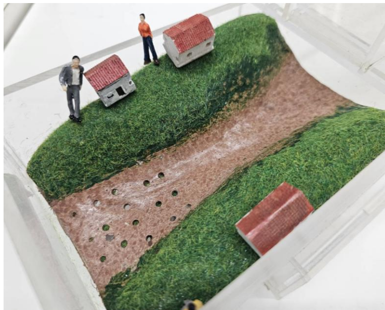
圖 3-23 堰塞湖型之發展形成及潰壩發生的歷程模型機關設計-下游
