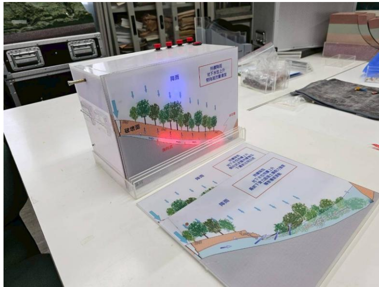
圖 3-3 降雨引致之滑動面發展與崩塌歷程模型
