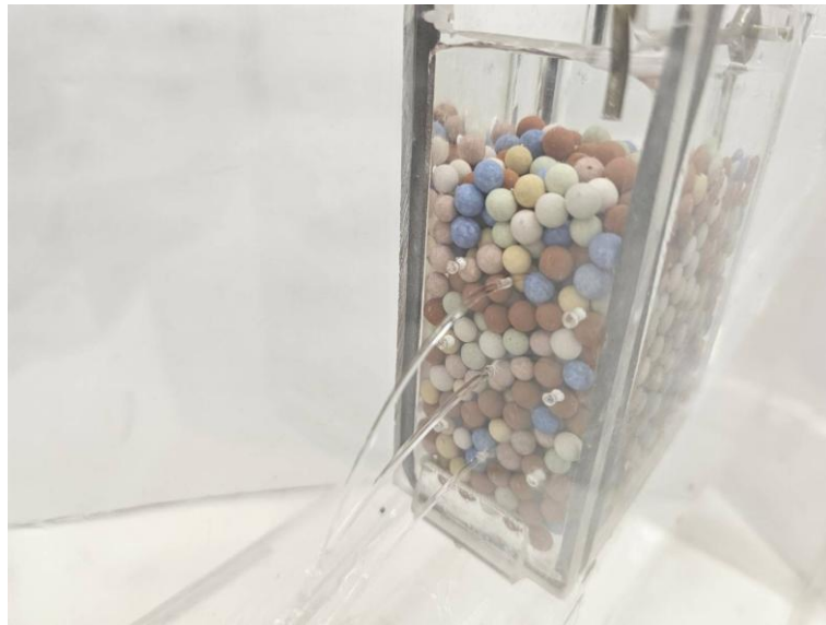
圖 3-24 堰塞湖型之發展形成及潰壩發生的歷程模型機關設計-模擬
