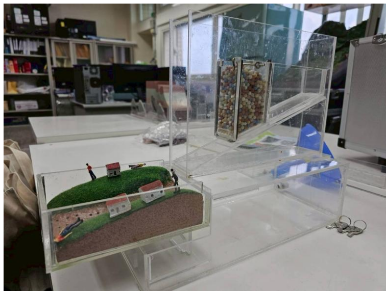
圖 3-6 堰塞湖型之發展形成及潰壩發生的歷程模型
