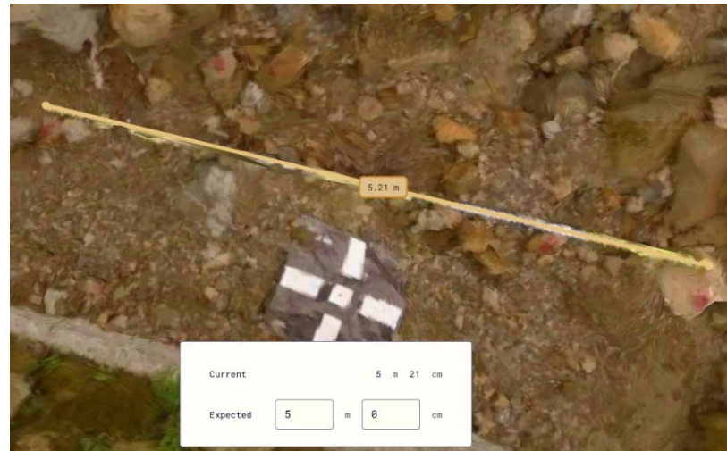
利用箱尺將比例尺進行校正
