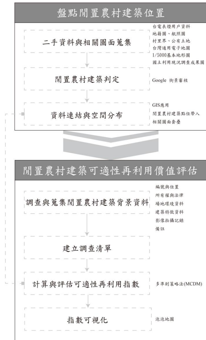
圖 13 閒置農村建築可適性再利用價值評估流程圖
