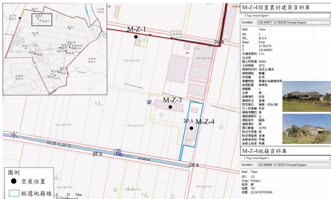
圖 19 套疊 1/5000 基本地形圖與地籍圖（以 M-Z-4 為例）
