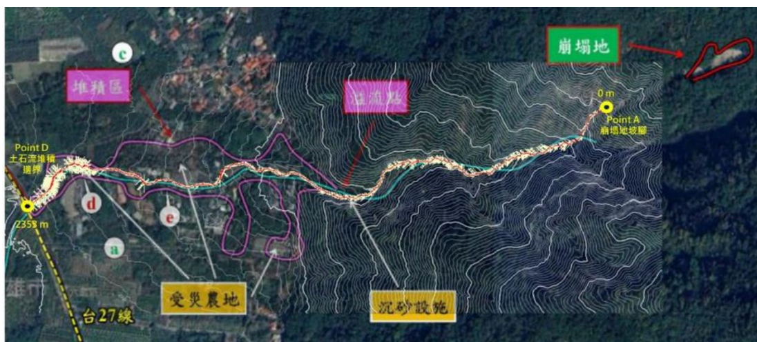
圖 4-14 高市 DF053 快速計算與凱米颱風土石流調查成果套繪，點 A 為崩塌坡腳，開始計算點，用降伏應力 10Pa，現場調查土方 30000m 3 ，利用快速計算法算出來的土石流最遠到達點為點 D，與現場調查影響範圍相同。
