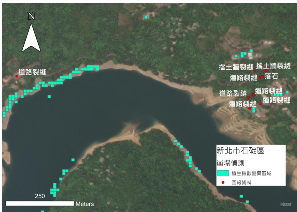
圖 3-4 Sentinel - NDVI 崩塌監測成果
