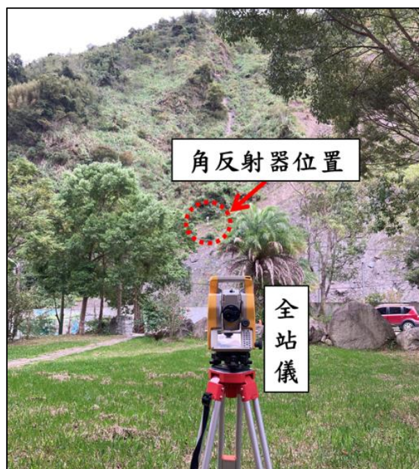
圖 3-47 以全站儀量測角反射器位移(113/10/28)
