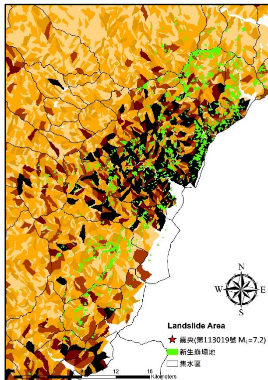
圖 5-39 震後坡地評估與新生崩塌地結果比較
