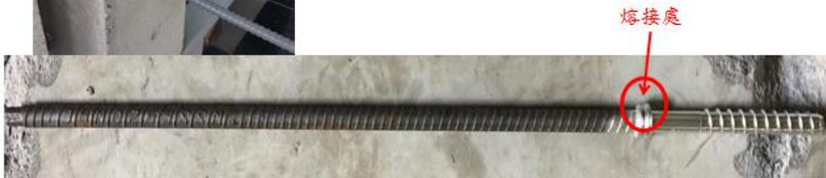
圖 1-15 新型螺紋植筋錨栓可應用結構補強施工中解決化學錨栓施工之不利條件
