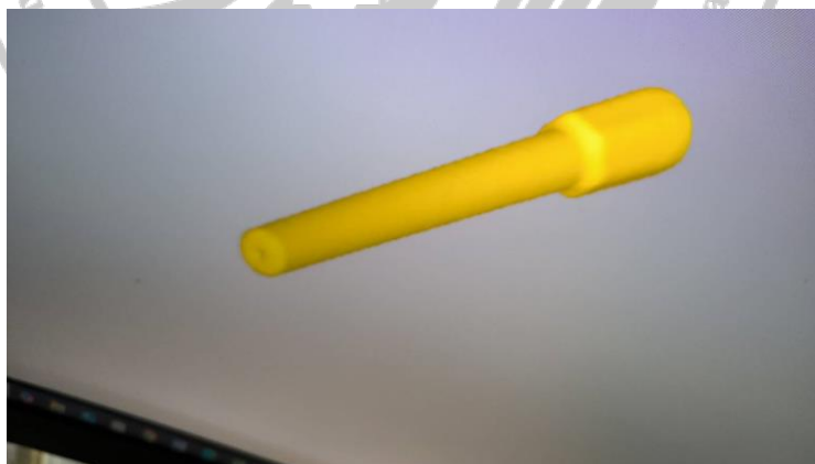
圖 3-36 經鍛造機壓製完成之螺紋錨栓初步形狀
