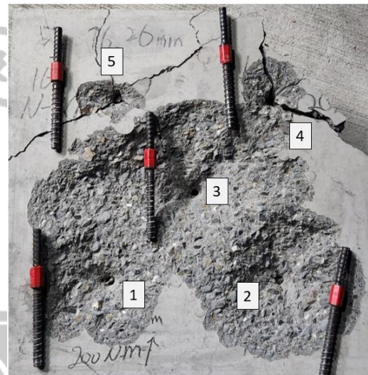
圖 3-5 Type A 錨栓植入 C 35/43 非開裂混凝土(2/A2) 非束制抗張試驗照片
