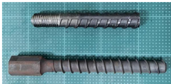
圖 3-1 修改設計及鋼質調整後之螺牙錨栓照片
