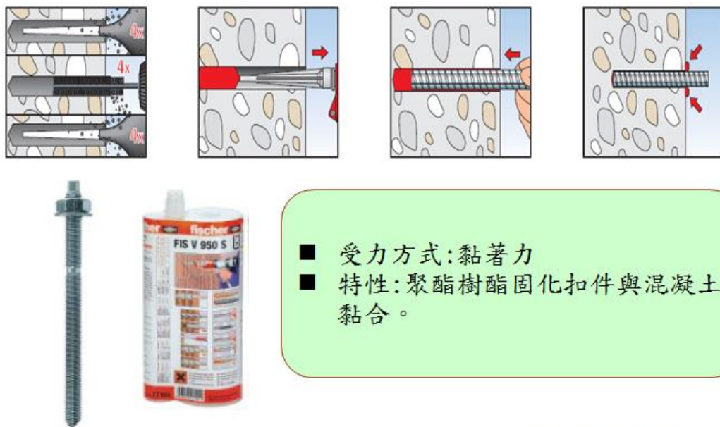
圖 1-7 化學植筋錨栓的施作與承載因素
