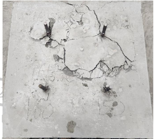
圖 3-13 Type B 錨栓植入 C 35/43 非開裂混凝土(2/A2) 非束制抗張試驗照片
