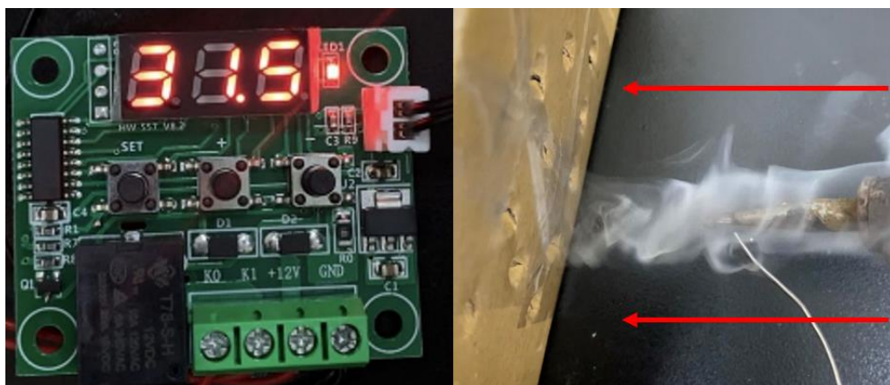
圖 2-127 溫度控制器盒內散熱測試結果
