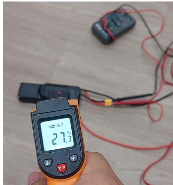
圖 2-52 對充電中的鋰聚合物電池進行溫度測量
