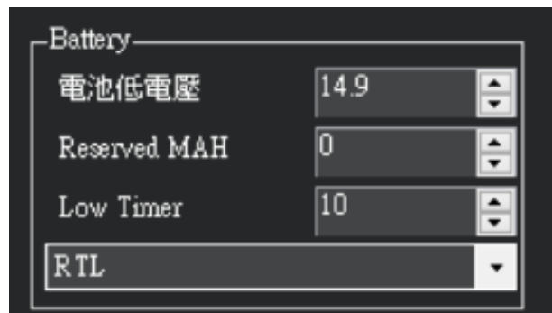
圖 2-66 電池低電壓保護設置
