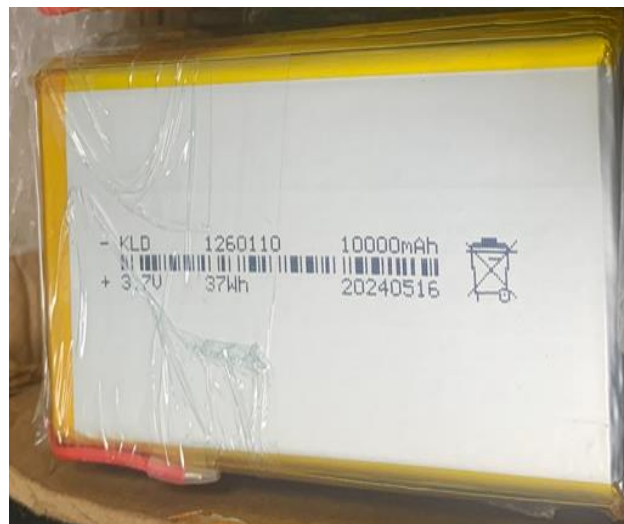
圖 2-119 鋰聚合電池規格
