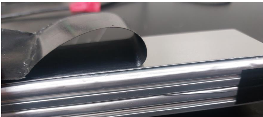
圖 2-48 電池內部之保護層及散熱板
