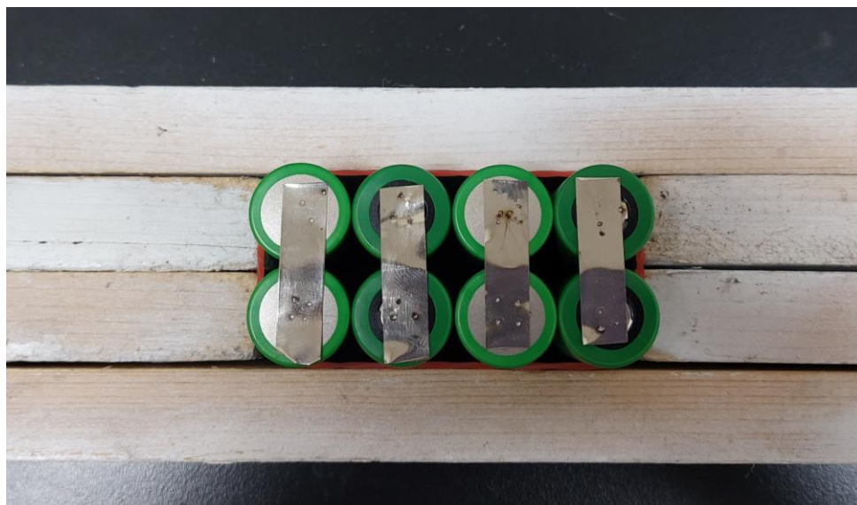
圖 2-41 以治具固定 18650 電池組
