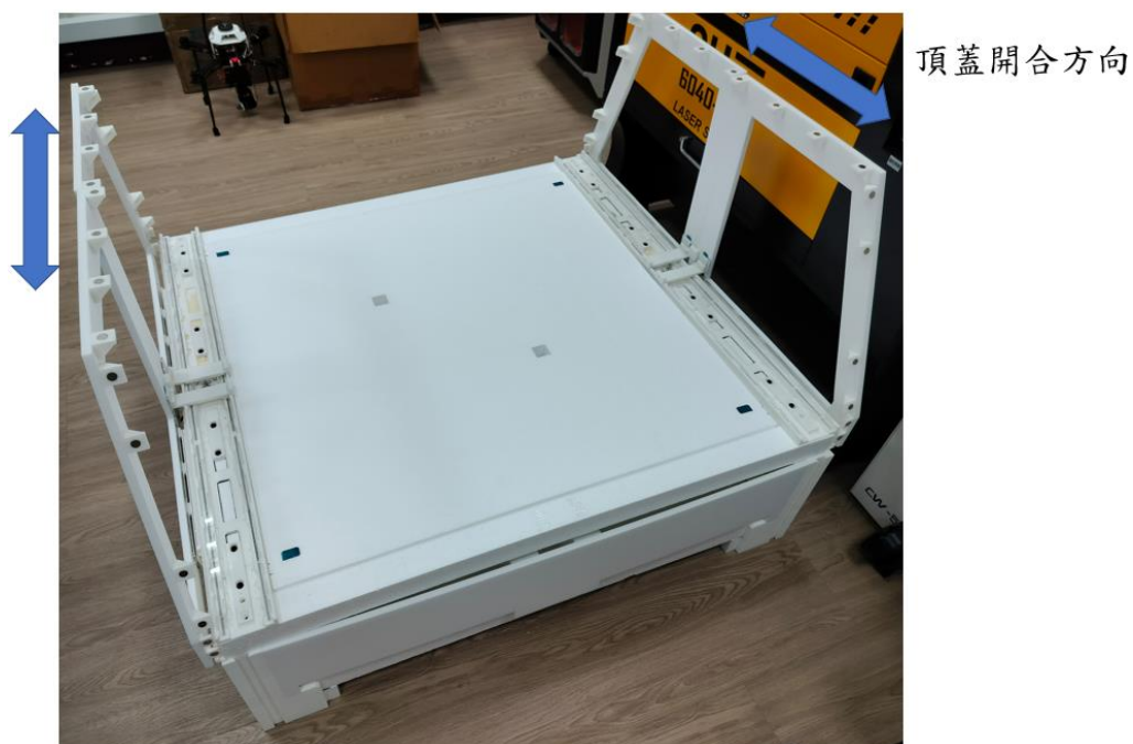
圖 4-4 左右軌道分別測試頂蓋開合
