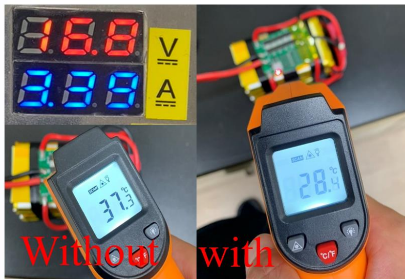
圖 2-123 未添加與添加散熱片溫度差異
