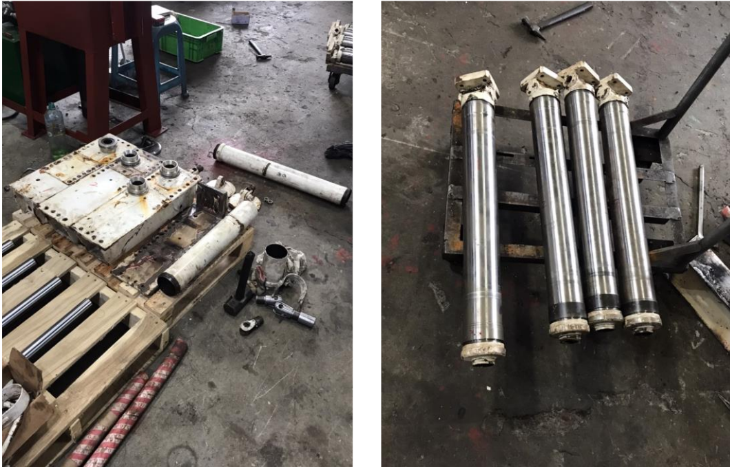
圖 3- 58 車廂整理(3)-液壓系統整理翻修
