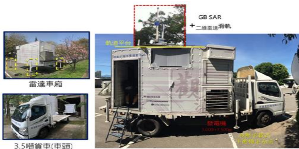
圖 3- 62 移動式雷達車廂及載具構想
