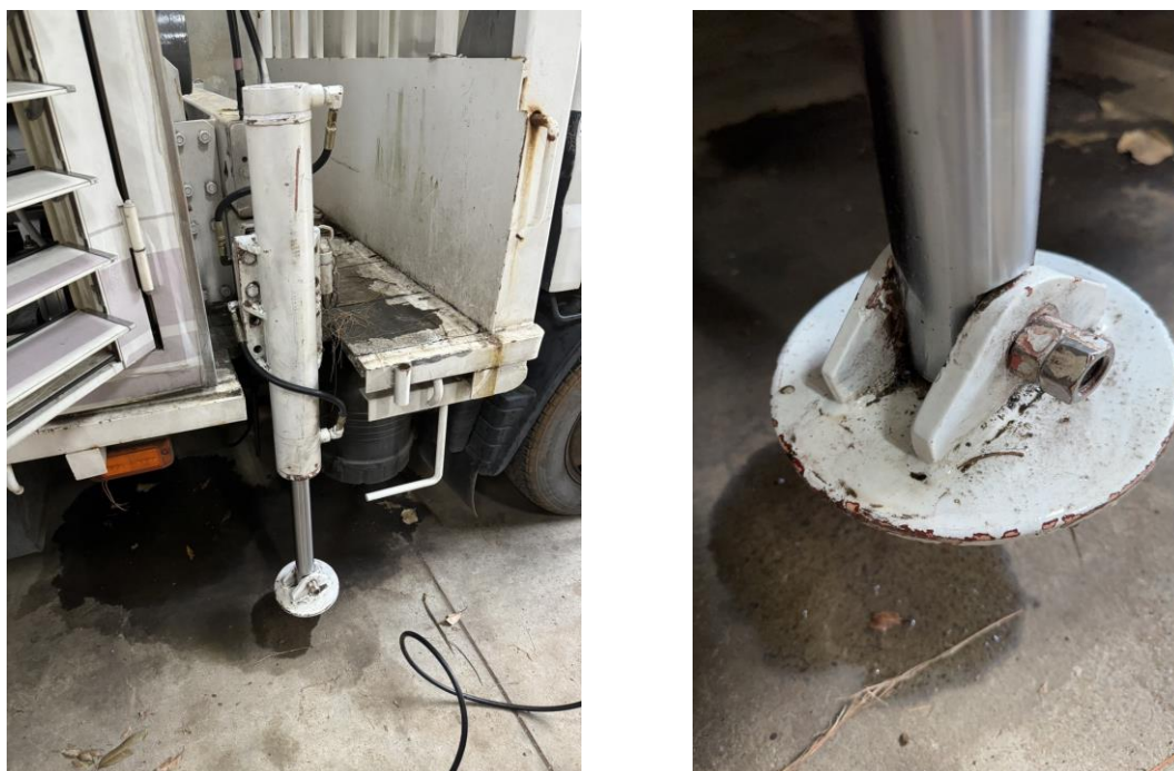
圖 3- 49 液壓系統漏油處理-漏油現象(2)
