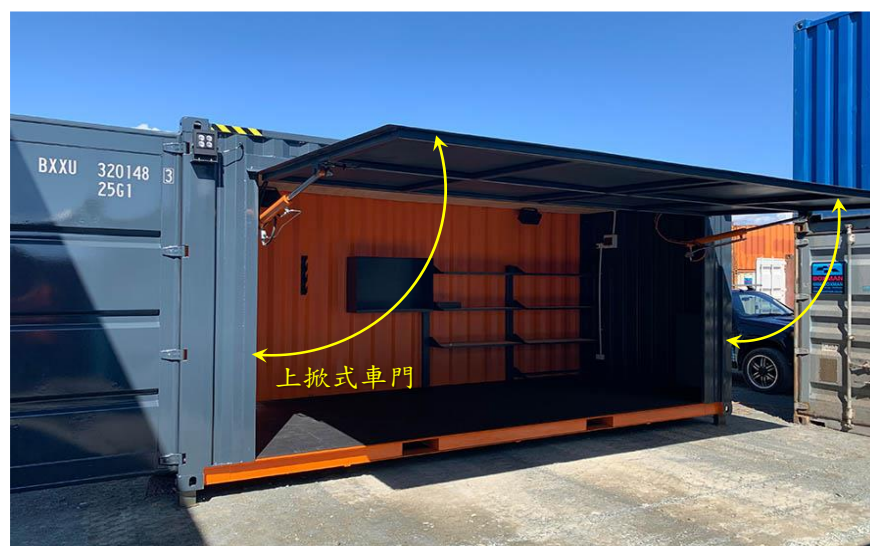
圖 3- 65 車廂修改規劃(1)-上掀式車門
