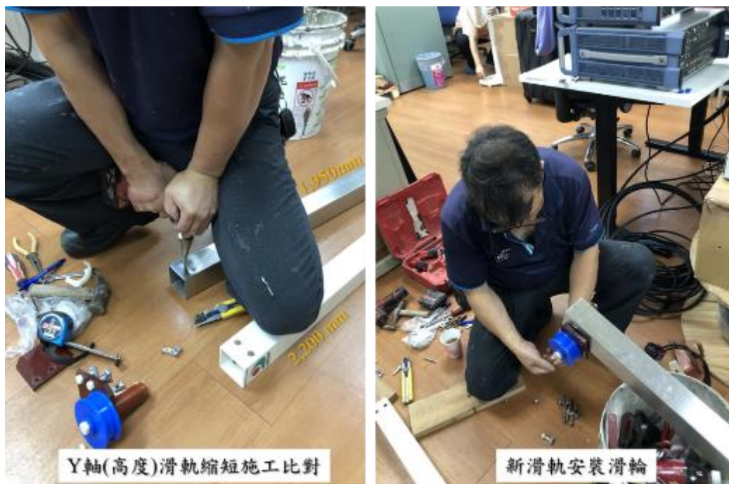
圖 3- 67 二維(XY)軸向掃描儀 Y 軸(高度)滑軌縮短優化
