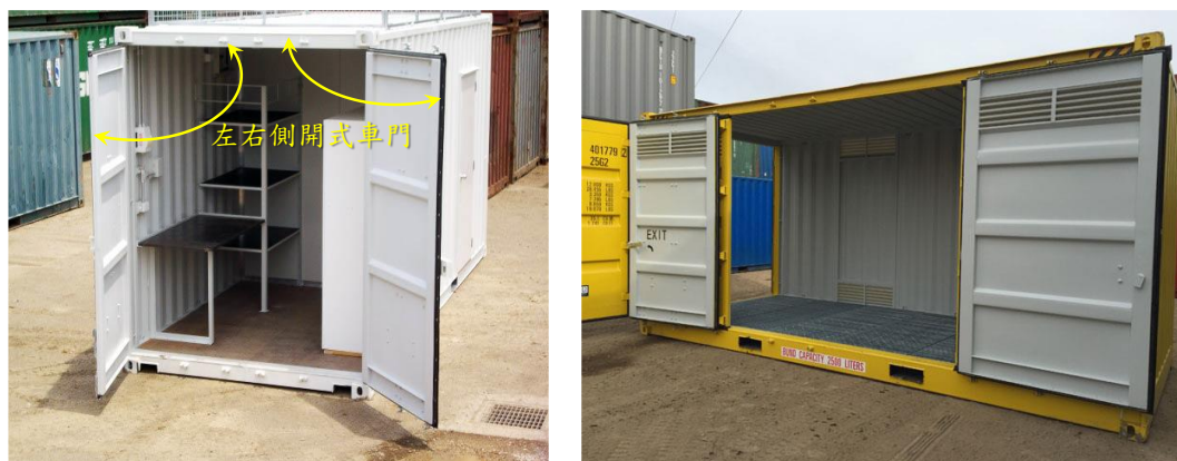
圖 3- 66 車廂修改規劃(2)-左右側開式車門
