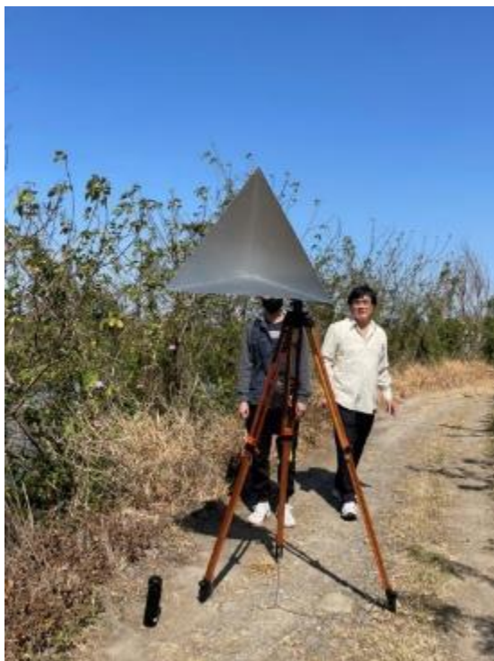
圖 3- 17 邊長 80 cm 三面(角錐)型角反射器戶外測試(1)
