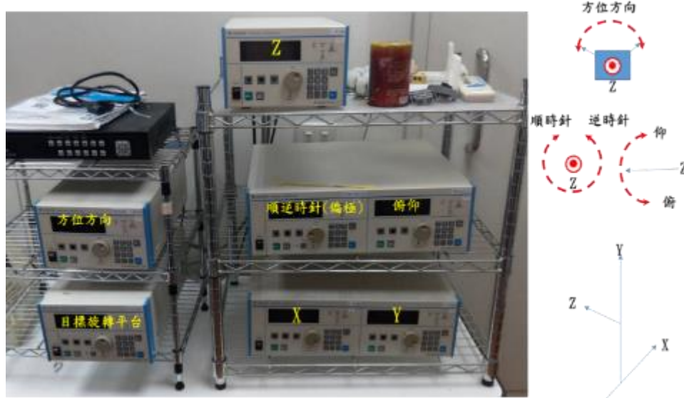
圖 3-8 GB-SAR 滑軌系統硬體控制功能
