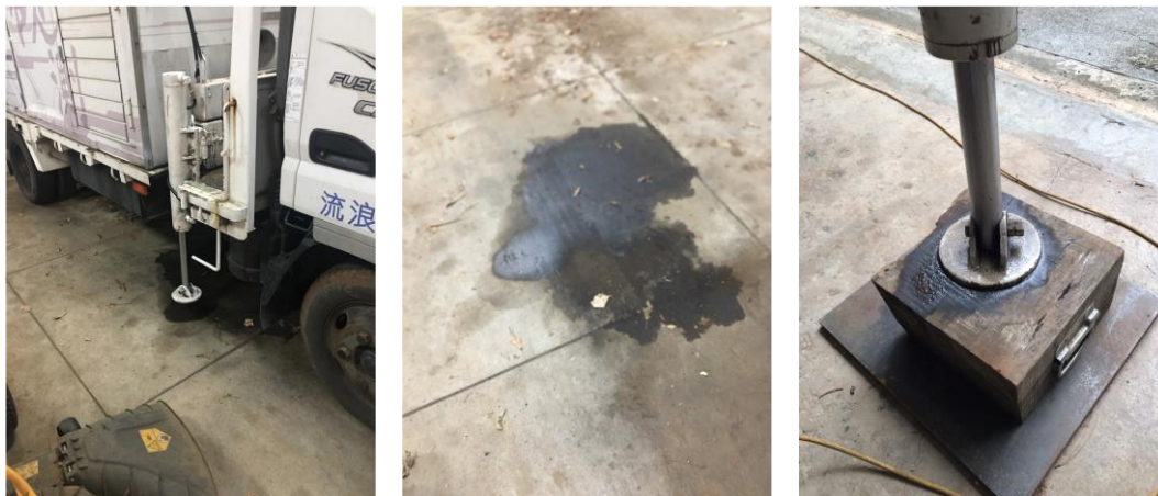
圖 3- 48 液壓系統漏油處理-漏油現象(1)
