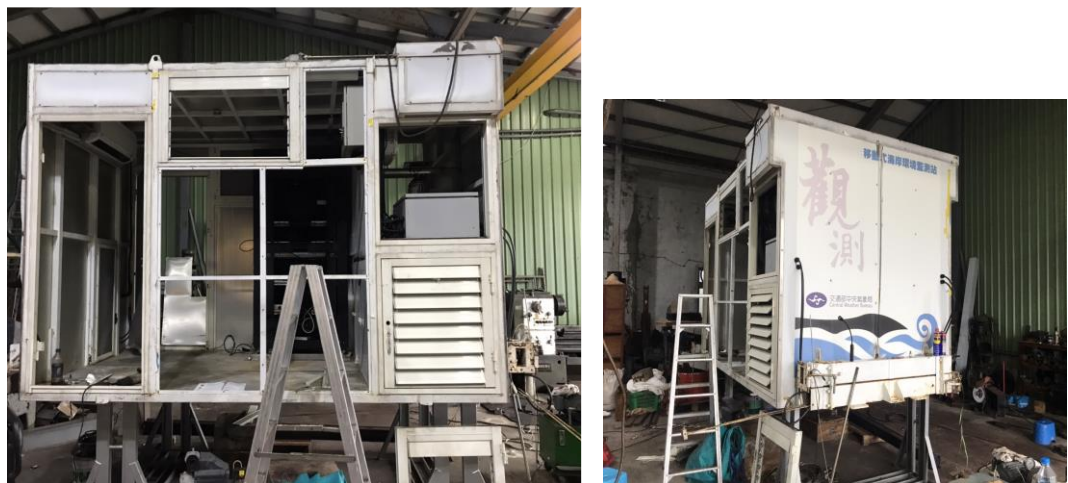
圖 3- 63 車廂整備(5)-結構補強
