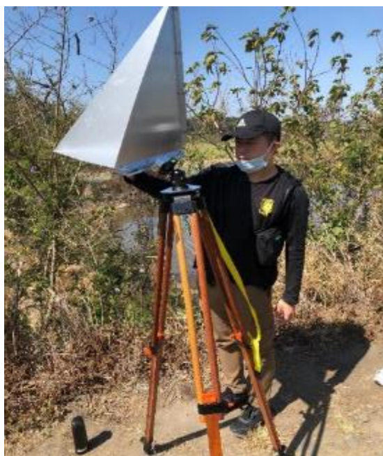
圖 3- 18 邊長 80 cm 三面(角錐)型角反射器戶外測試(2)
