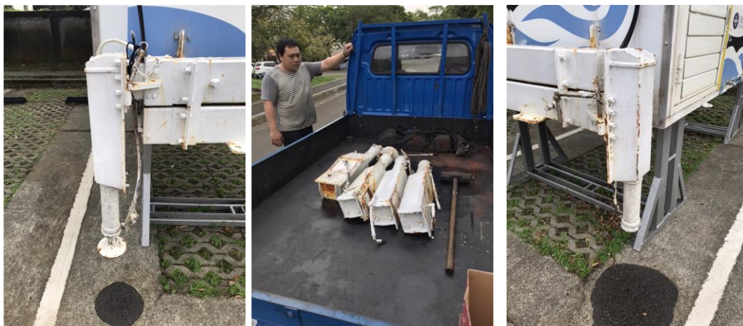
圖 3- 56 車廂整理(1)-液壓系統整理翻修
