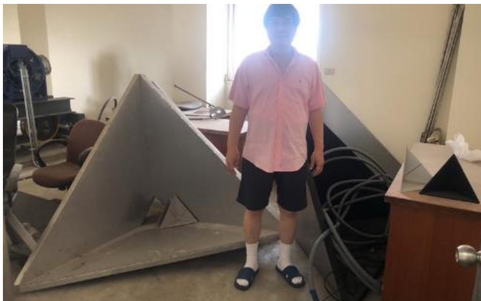
圖 3- 19 邊長 170 cm 三面(角錐)型角反射器
