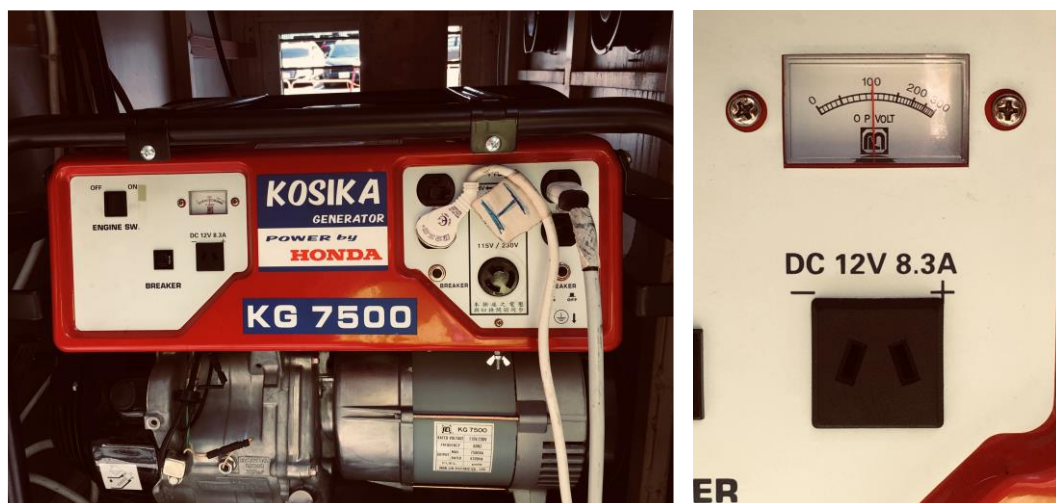
圖 3- 45 GB-SAR 車廂發電機(2)-電壓檢測
