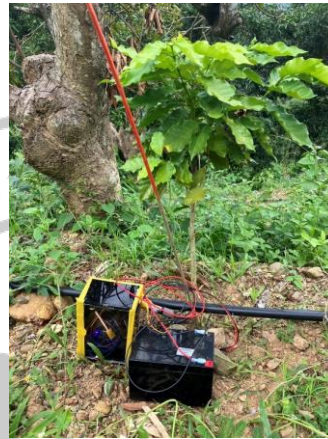
圖 3-24 12 V 鉛酸電瓶電能供應田間感測器
