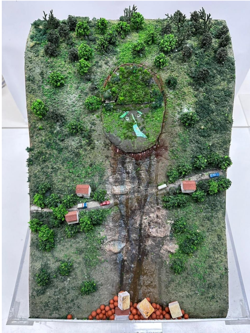
圖 3-14 重力堆積型模型之土石顆粒崩落
