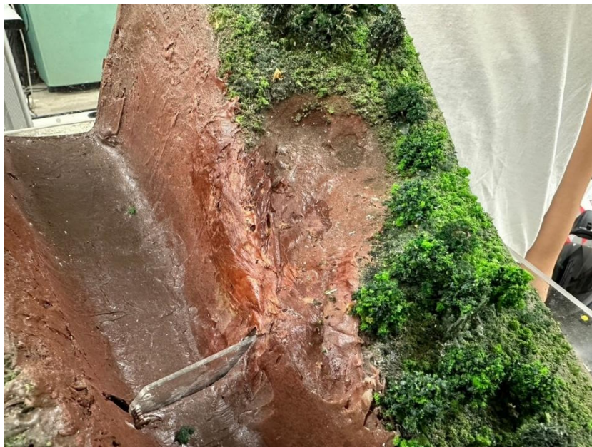
圖 3-11 堰塞湖型模型特寫—崩塌料源
