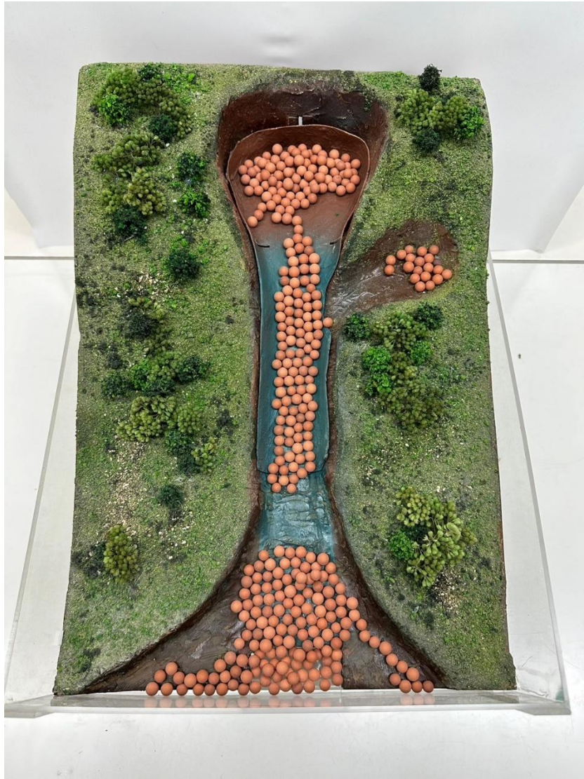
圖 3-17 土石流型模型坡度較緩之土石流潛勢溪流
