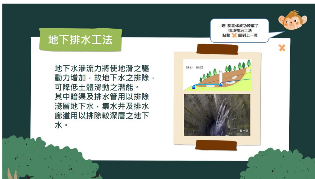
圖 3-53 治理工法說明-地下排水工法
