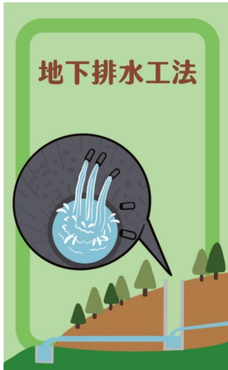
圖 3-37 治理工法感應幣-地下排水工法
