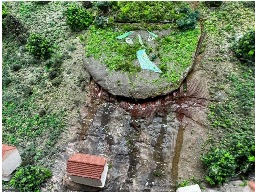
圖 3-12 重力堆積型模型之滲水機關
