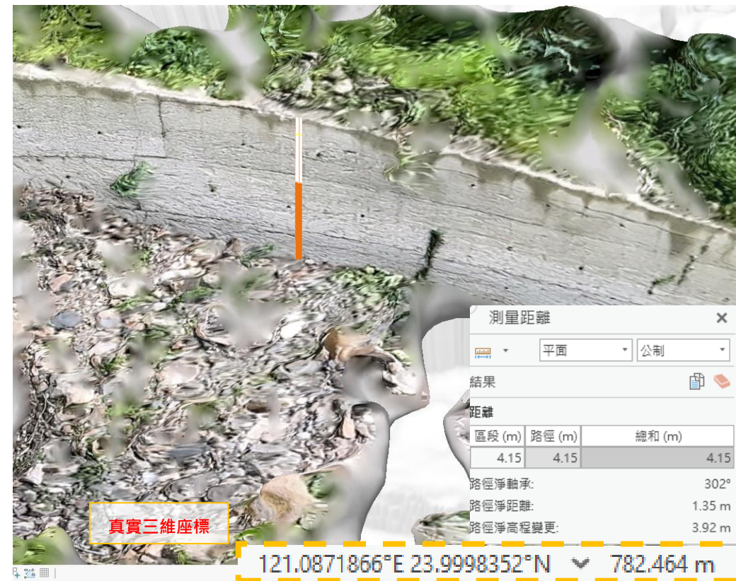
可巡檢量化防砂構造物通洪斷面高 (護岸通洪斷面高:4.15m)
