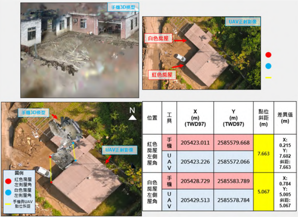
圖 2-39 LiDAR 掃描測繪法之 3D 模型-保全對象
