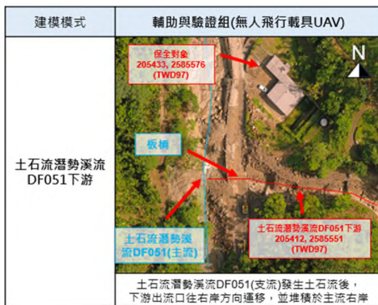
圖 2-21 土石流潛勢溪流下游出口口 3D 建模成果(2)
