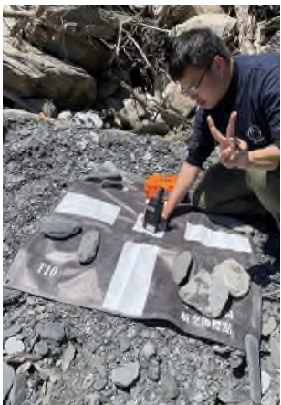
即時動態定位(RTK) -固定解
