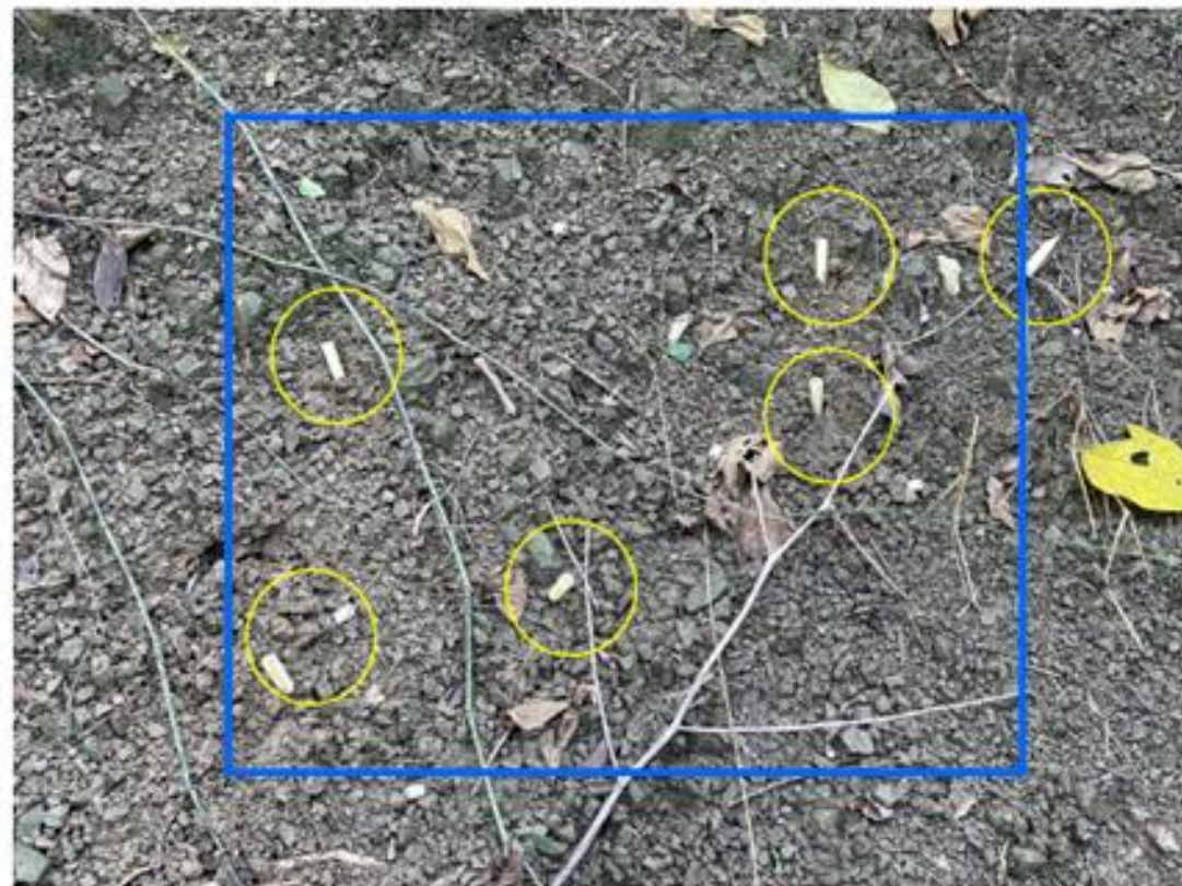
圖 2.9.27：9 月 28 日南化水庫 A 區 PVA 木本噴植 狀況 (方塊內為 1 平方公尺)
