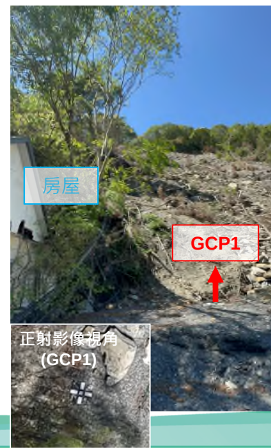
正射影像(20240312)-單點定位研究用控制點位置圖
