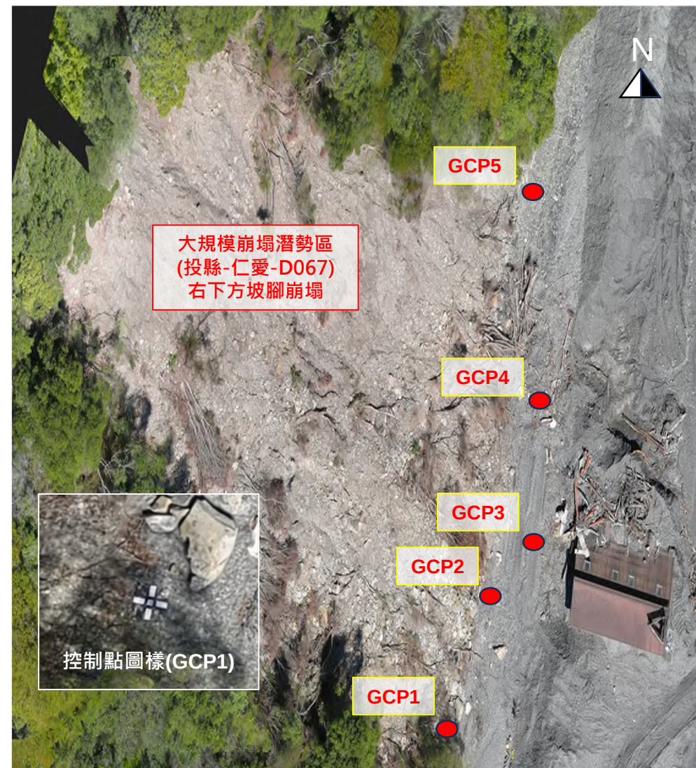
正射影像(20240312)-單點定位研究用控制點位置圖
