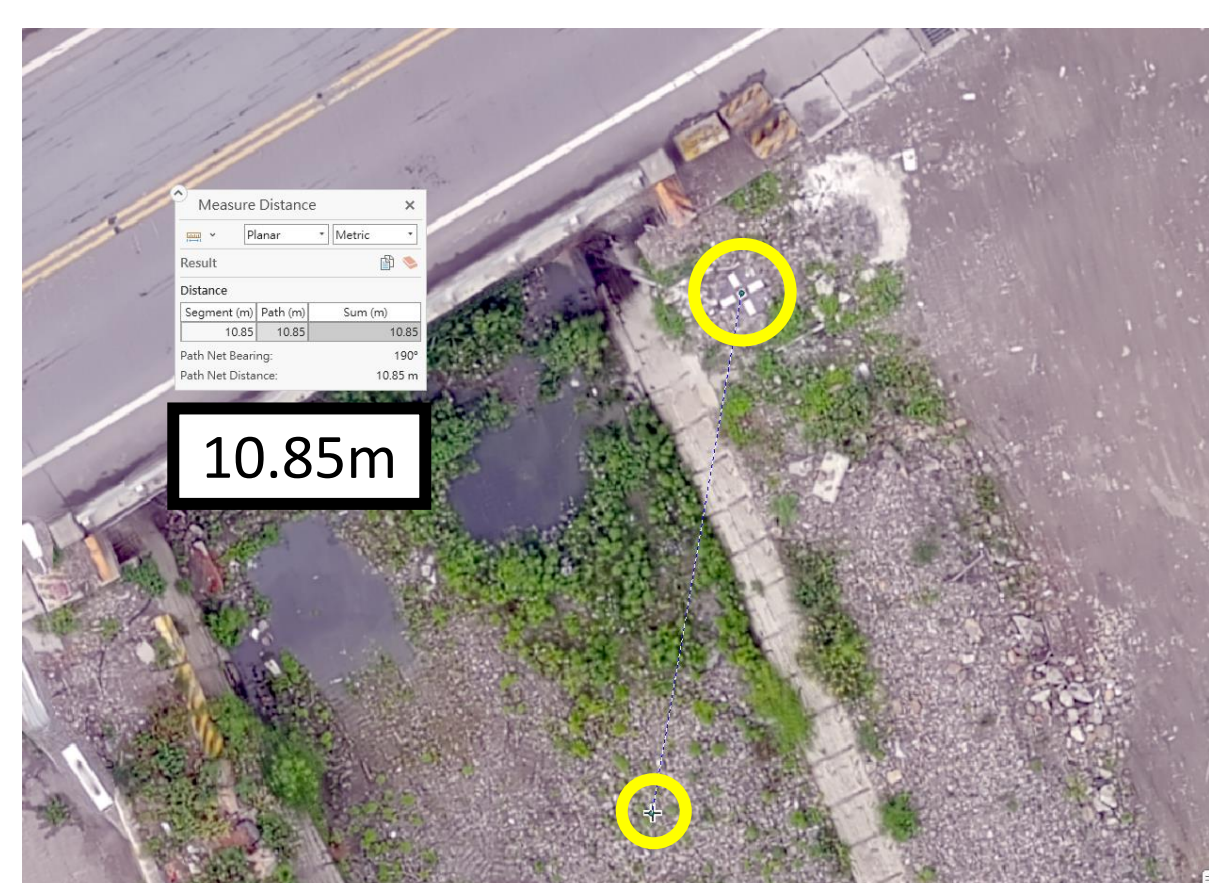
圖二、未加控制點的正射影像上的控制點T005與外業量測的座標的位置偏移狀況。
