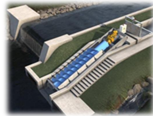
螺旋式水輪機(阿基米德式)
