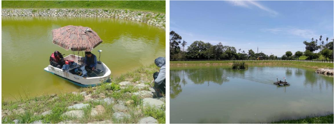
圖 4-1 自製小艇（左）及無人船（右）執行農塘水深測量作業
