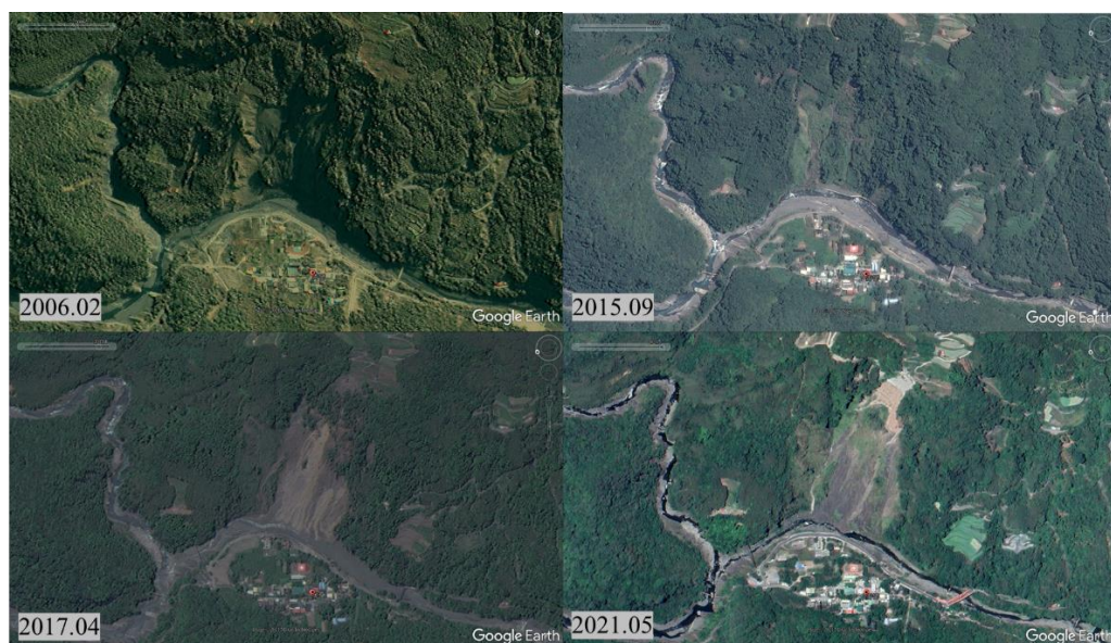
圖 1-4 DS194 崩塌地逐年變遷影像(Google Earth)
