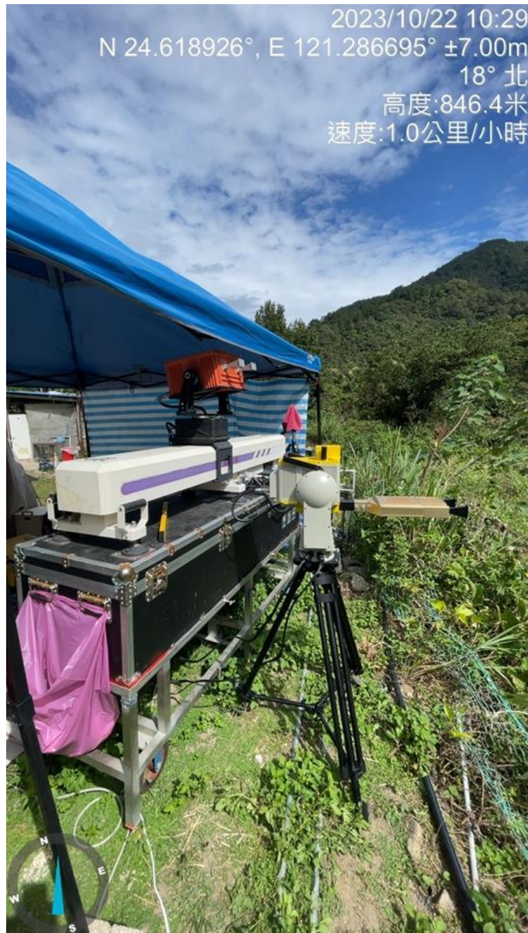
圖 4-33 Linear SAR(左)與 ArcSAR(右)同時掃描 DS194 崩塌地
