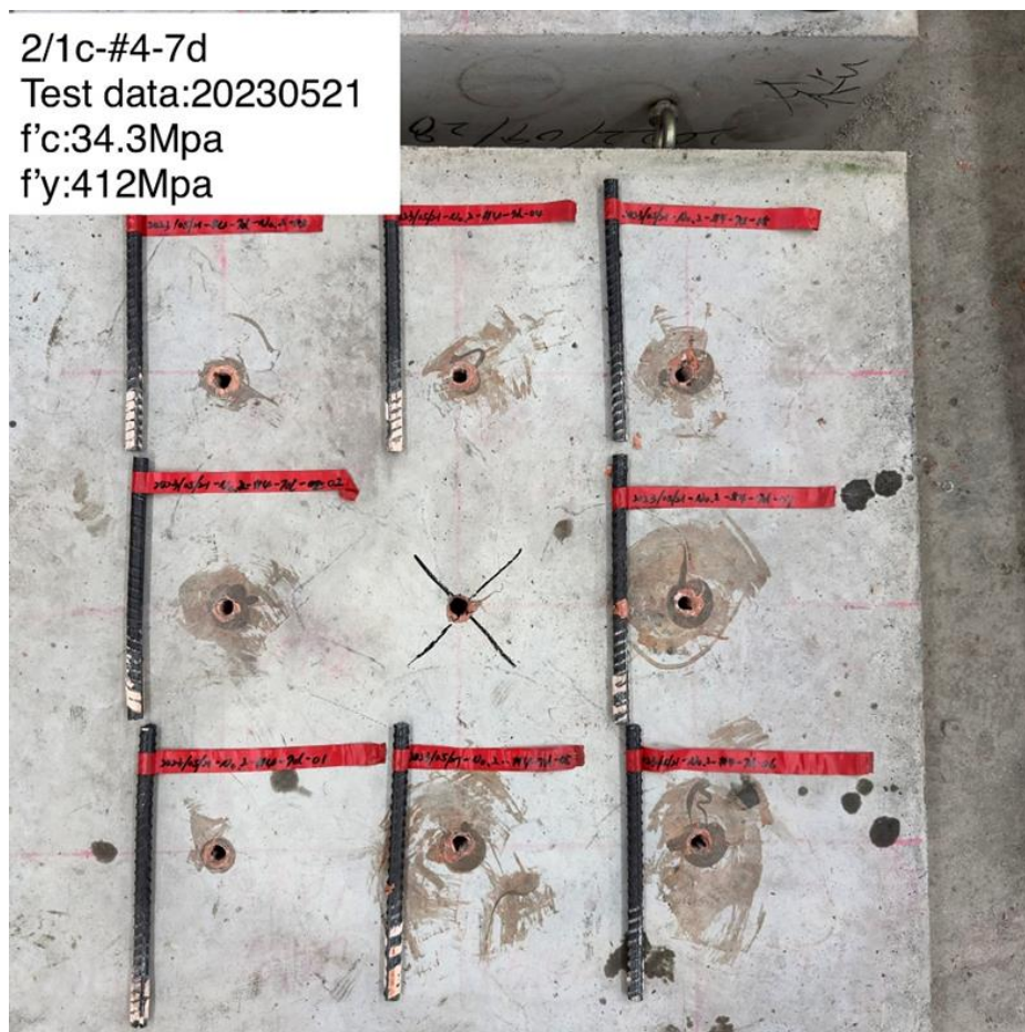
圖 3-6 #4 化學植筋植入 C35/43 混凝土 7d 植入深度參考性 1c/2 試驗照片
