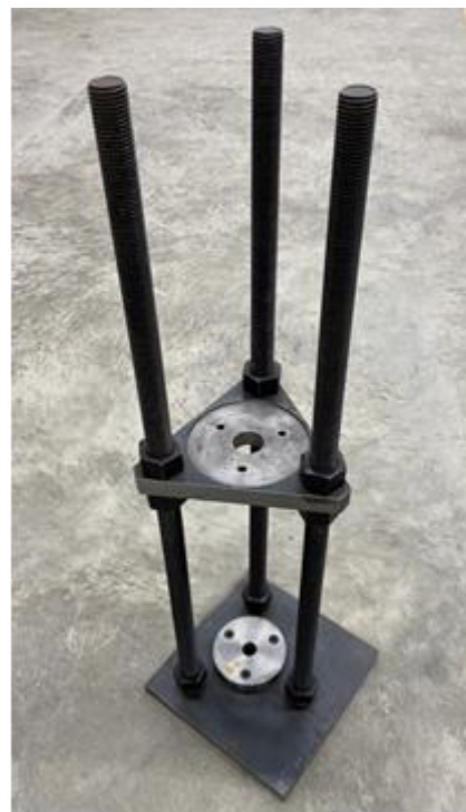
圖 2-10 侷限式拉伸試驗架設設備
