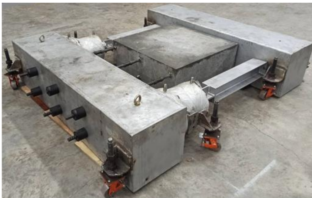
圖 2-11 開裂混凝土反力架油壓系統
