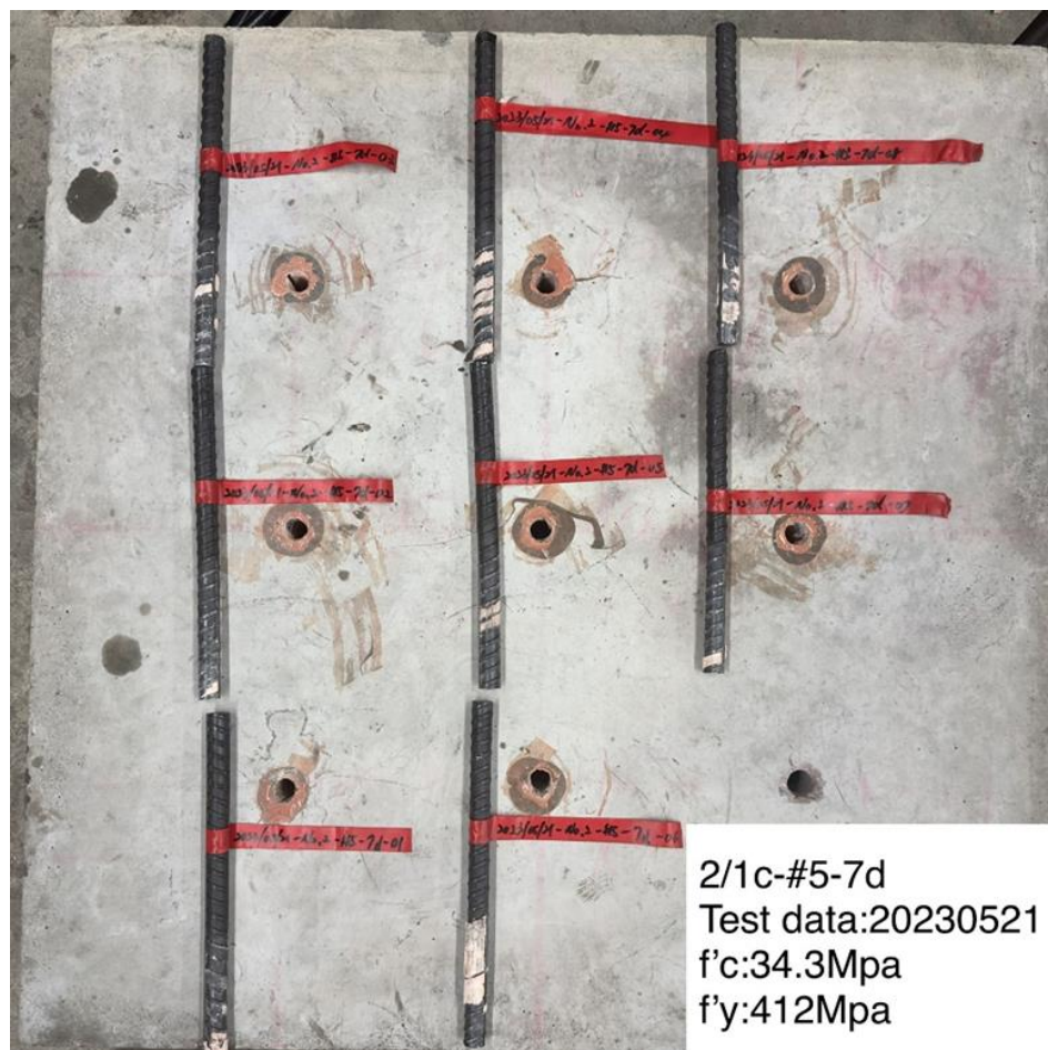
圖 3-10 #5 化學植筋植入 C35/43 混凝土 7d 植入深度參考性 1c/2 試驗照片
