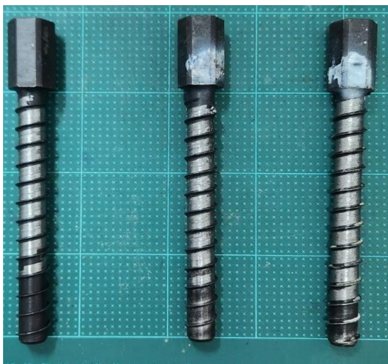
圖 3-20 修改螺牙與螺桿後之 M24 母頭新式螺紋植筋錨栓
