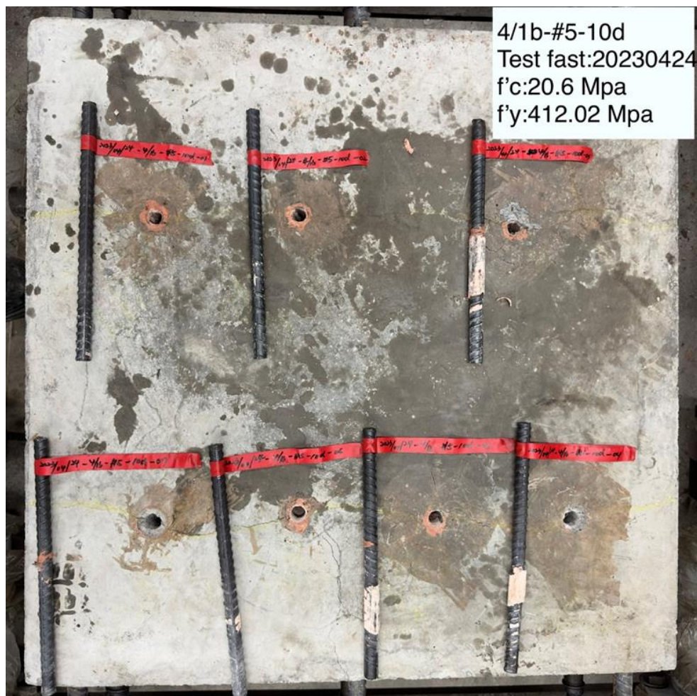
圖 3-9 #5 化學植筋植入 C20/25 裂紋混凝土 10d 植入深度參考性 4/1b 試驗照片(7 samples)
