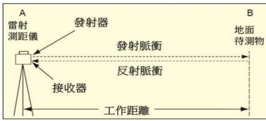
圖 2-5 光達原理示意圖(王星為等，2017)。
