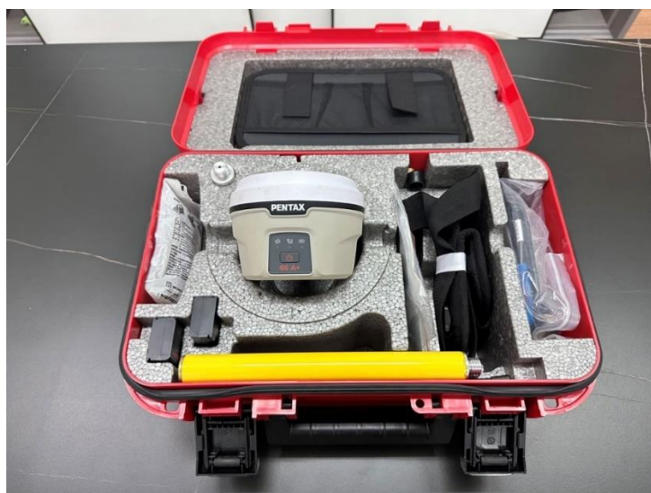
圖 3-6 Pentax G6 A+衛星定位接收器。
